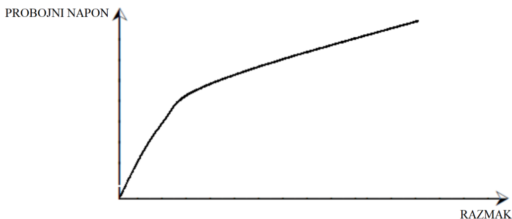
Slika 2.3 Karakteristika probojnog napona mjenog kuglastim iskrištem [2]
