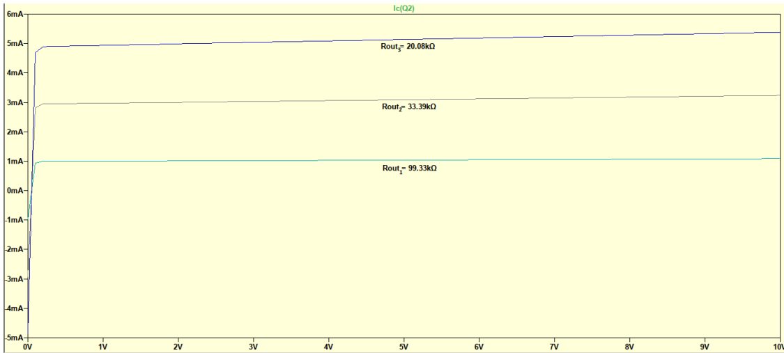
Slika 19. Grafički prikaz ovisnosti izlazne struje o naponu s prikazanim pripadnim vrijednostima otpora – rezultat simulacije temeljen na električnoj shemi strujnog zrcala s kompenziranom bazom sa slike 18
