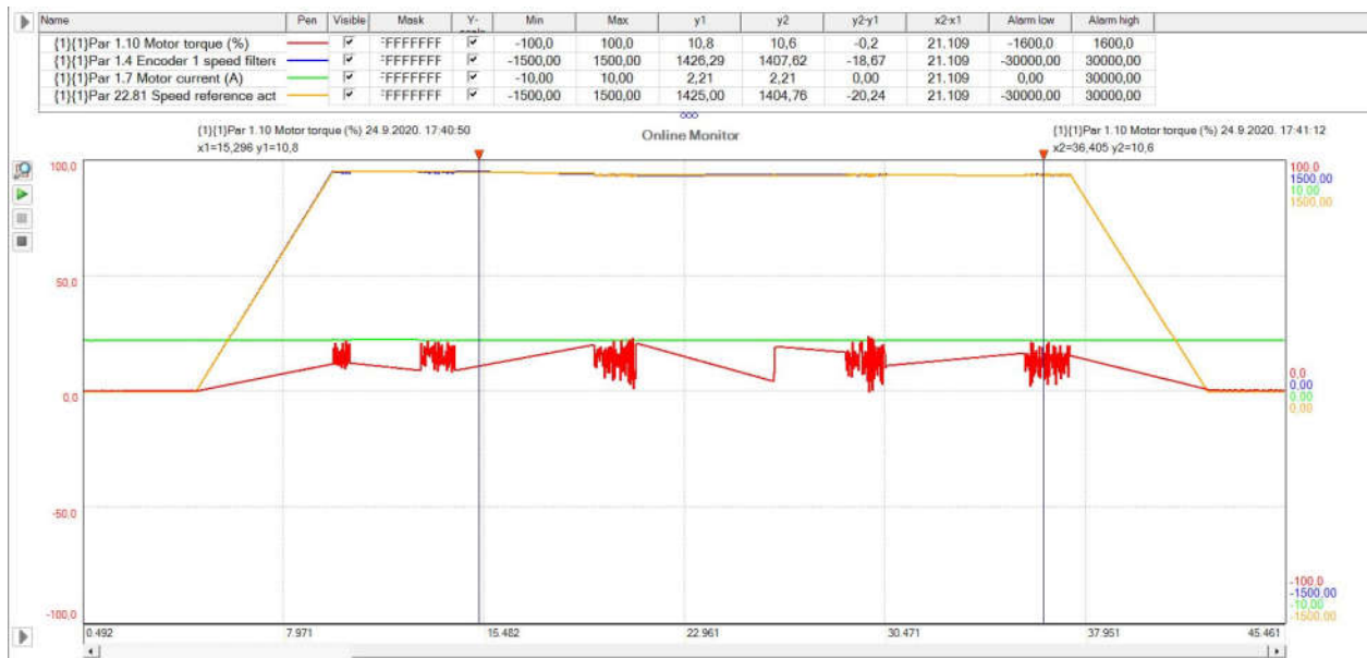
SI. 6.2. Prikaz veličina elektromotora uz Droop
