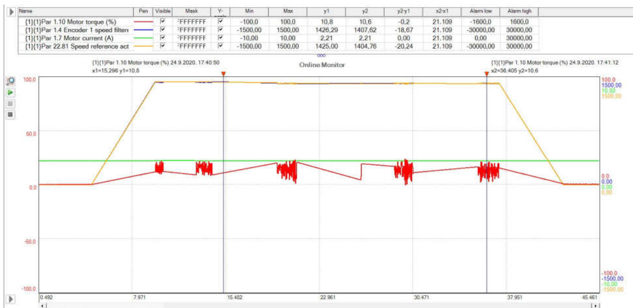
Sl. 6.8. Postupni zalet asinkronog motora na nazivnu brzinu vrtnje
