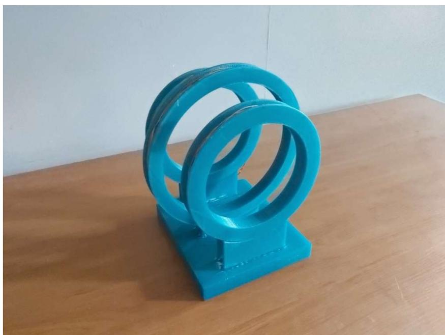
**Slika 4.20** – Fizička maketa Maxwellovog sustava svitaka
