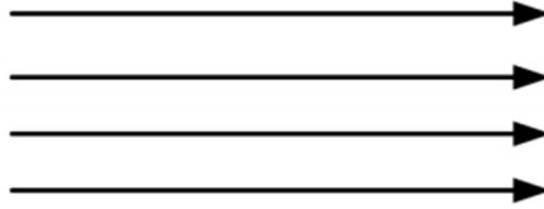
**Slika 2.1** - Silnice homogenog magnetskog polja
