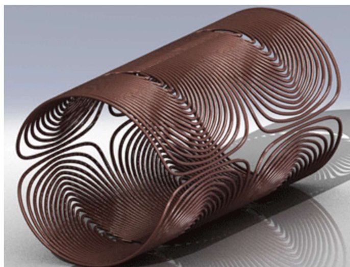
Slika 3.9 – Golayev sustav svitaka u obliku otiska prsta [17]
