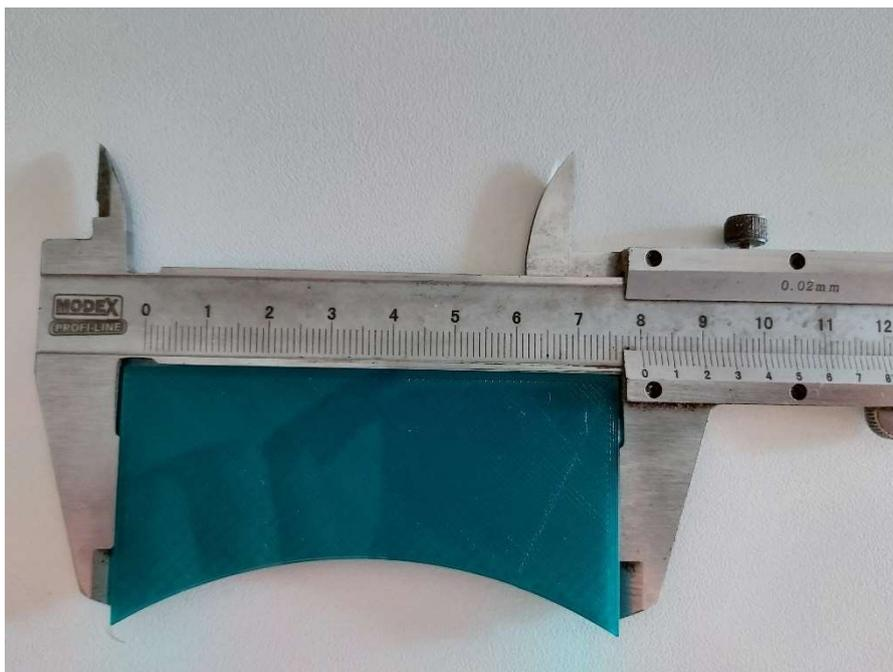
**Slika 4.19** – Prikaz preciznosti dimenzija pri 3D printanju
