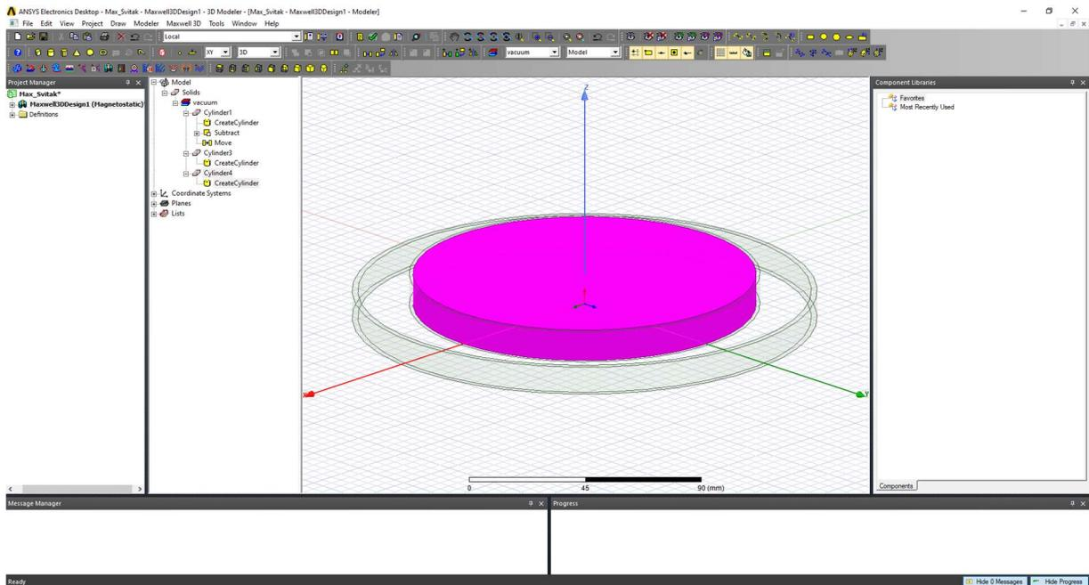
Slika 6.23 – Konačni srednji cilindar vanjskog svitka
