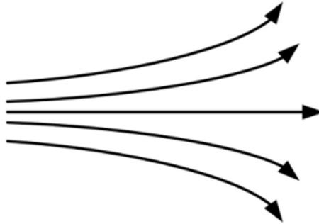
**Slika 2.2** - Prikaz silnica nehomogenog magnetskog polja
