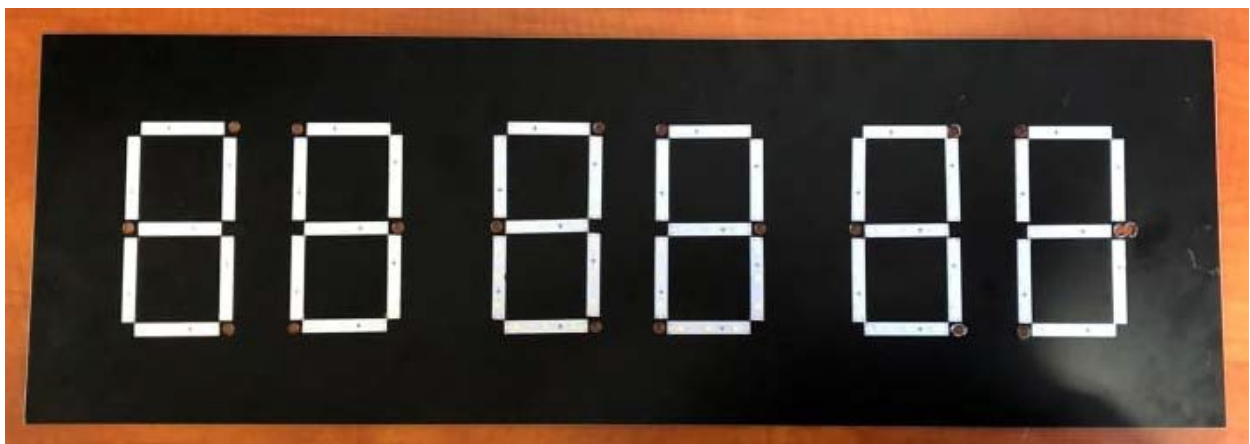
Slika 4.1. LED trakice spojene na ploču
