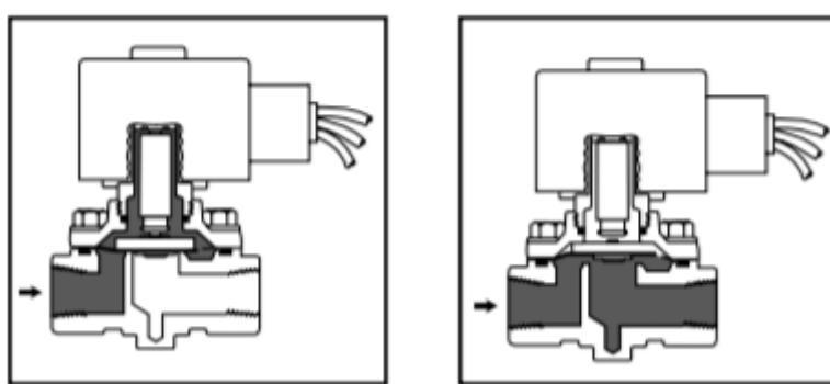
*Slika 3.1: Dijagram rada normalno zatvorenog elektromagnetskog ventila bez i sa dijelovanjem napona[3].*
