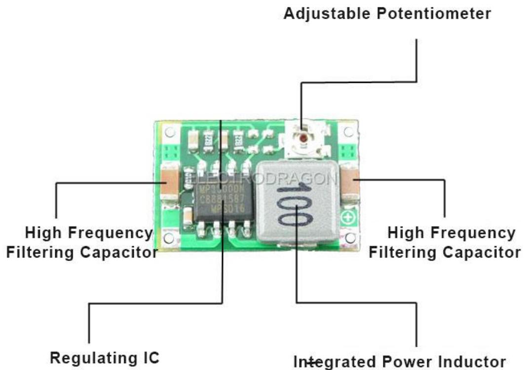
**Slika 3.11:** MP2307 Step-Down modul sa prikazima glavnih elemenata.
