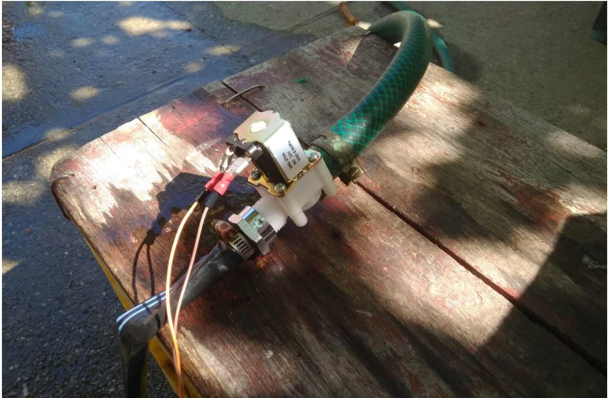
**Slika 4.8:** Magnetni ventil spojen na vrtno crijevo i crijevo za kap po kap navodnjavanje.
