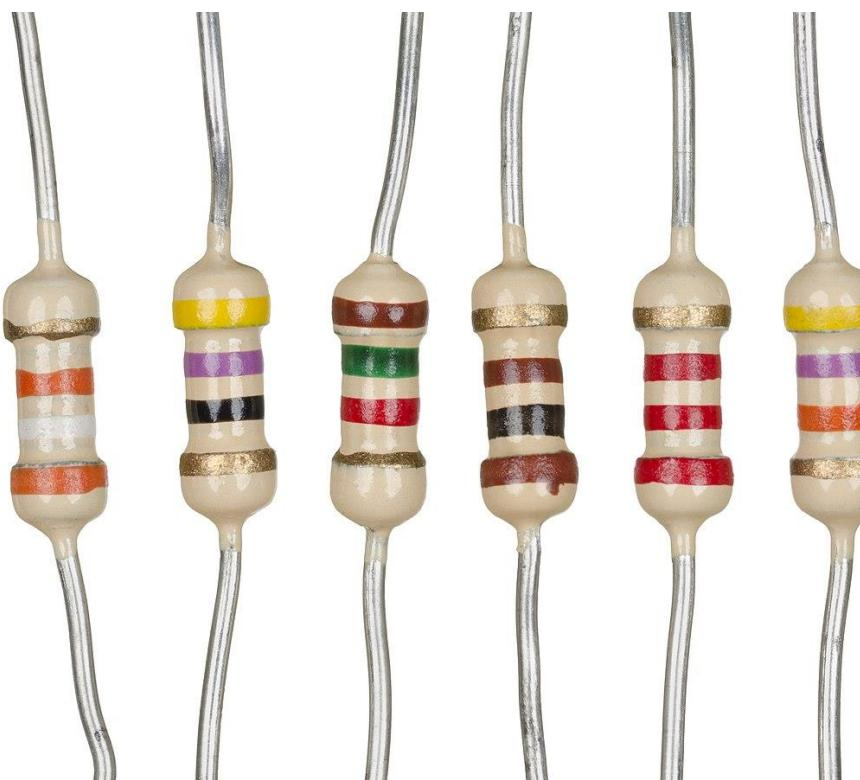
Slika 3.7: Primjer otpornika.
