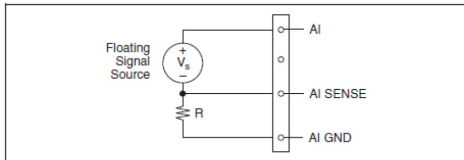
Slika 2.7.4. NRSE spoj za neuzemljeni izvor signala
