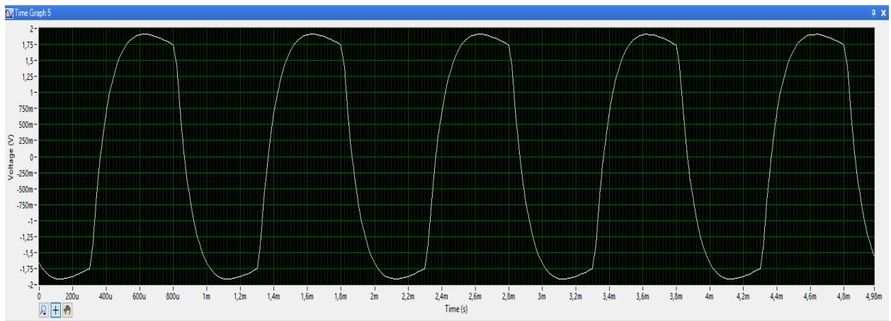
**Slika 3.3.7.** Valni oblik napona na otporniku  $U_R$
