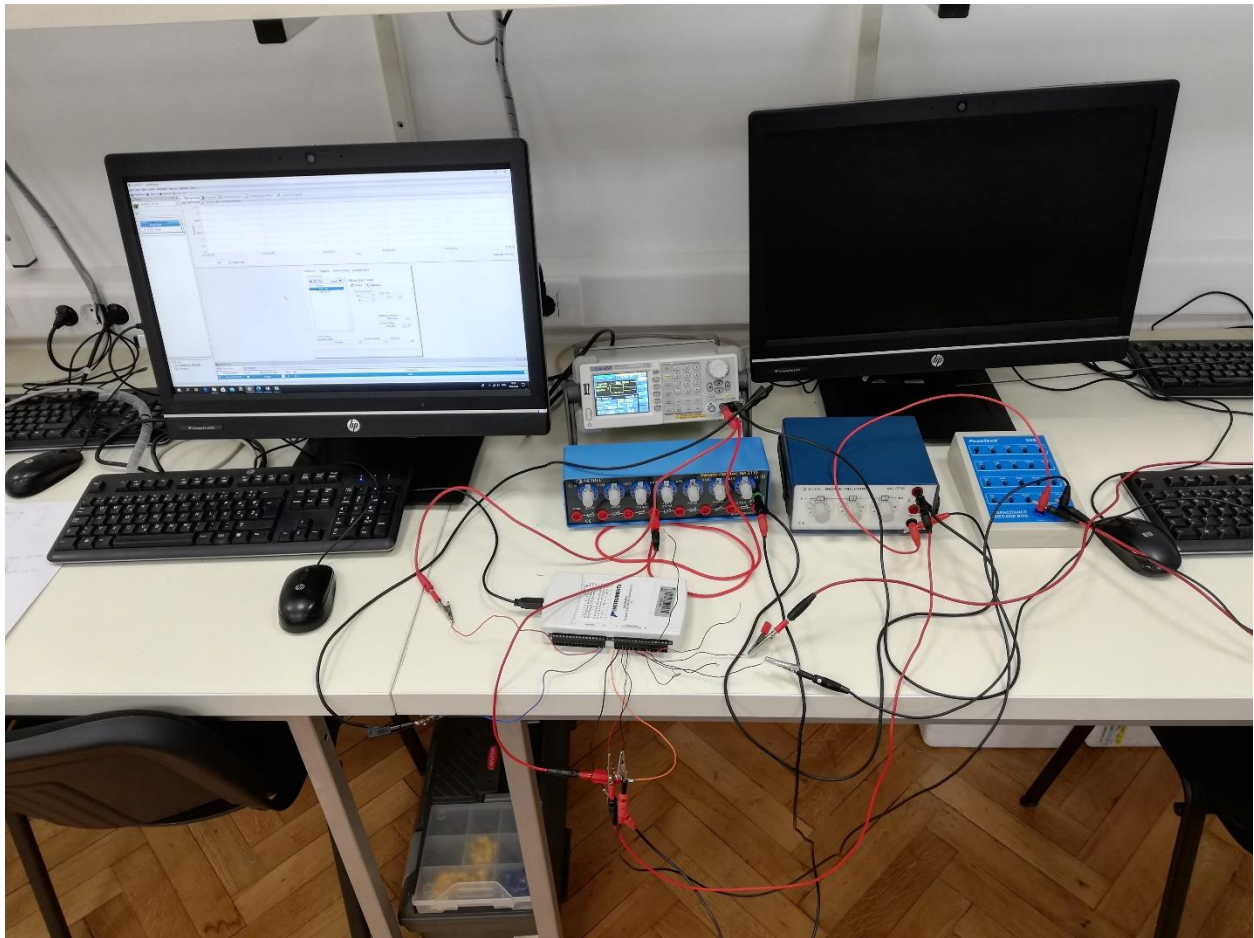
Slika 3.3.4. Slika spojenog serijskog RLC kruga s AD karticom
