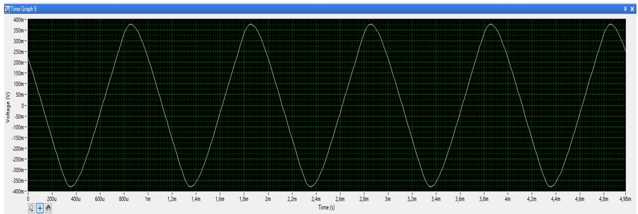
**Slika 3.3.9.** Valni oblik napona na kondenzatoru  $U_C$
