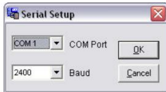
Slika 4.1 Prozor za postavljanje serijske komunikacije s brojilom [11]
