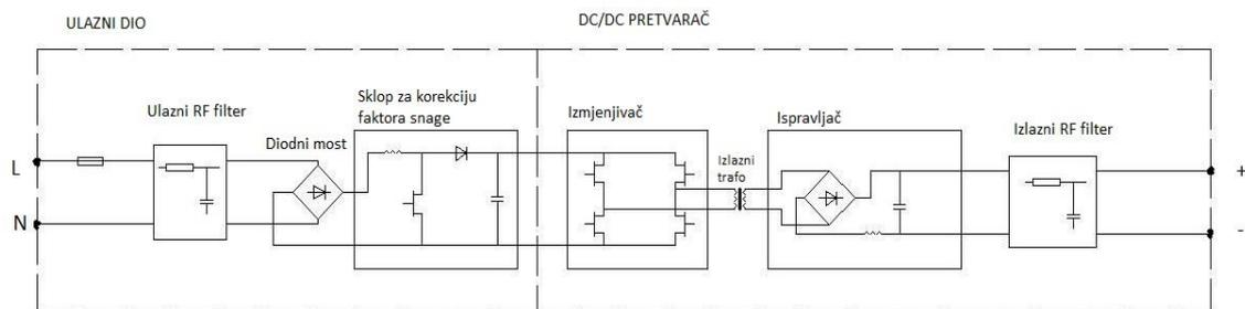
Slika 4.2. Blok shema ispravljača [1]
