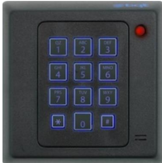
Slika 2.3. Industrijska tipkovnica izrađena od gume [3]
