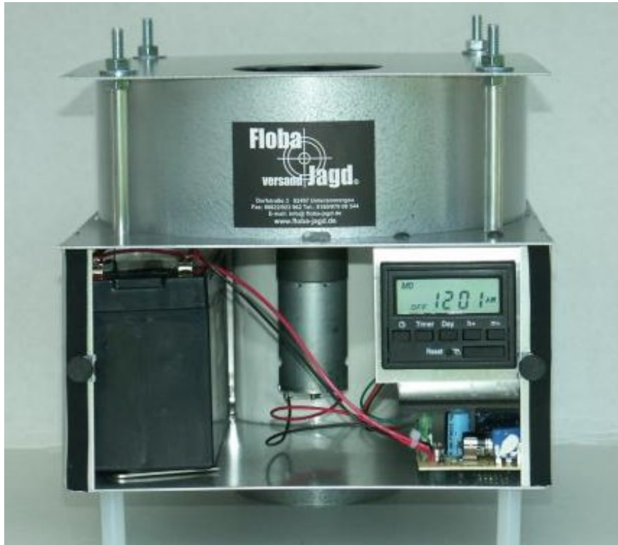
Slika 2.7. Automatska hranilica „ Floba Jagd 12V DROP “ [5]
