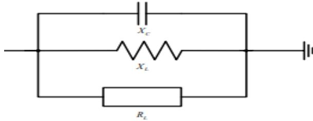
**Slika 4.5.** Model opterećenja simulirane mreže
