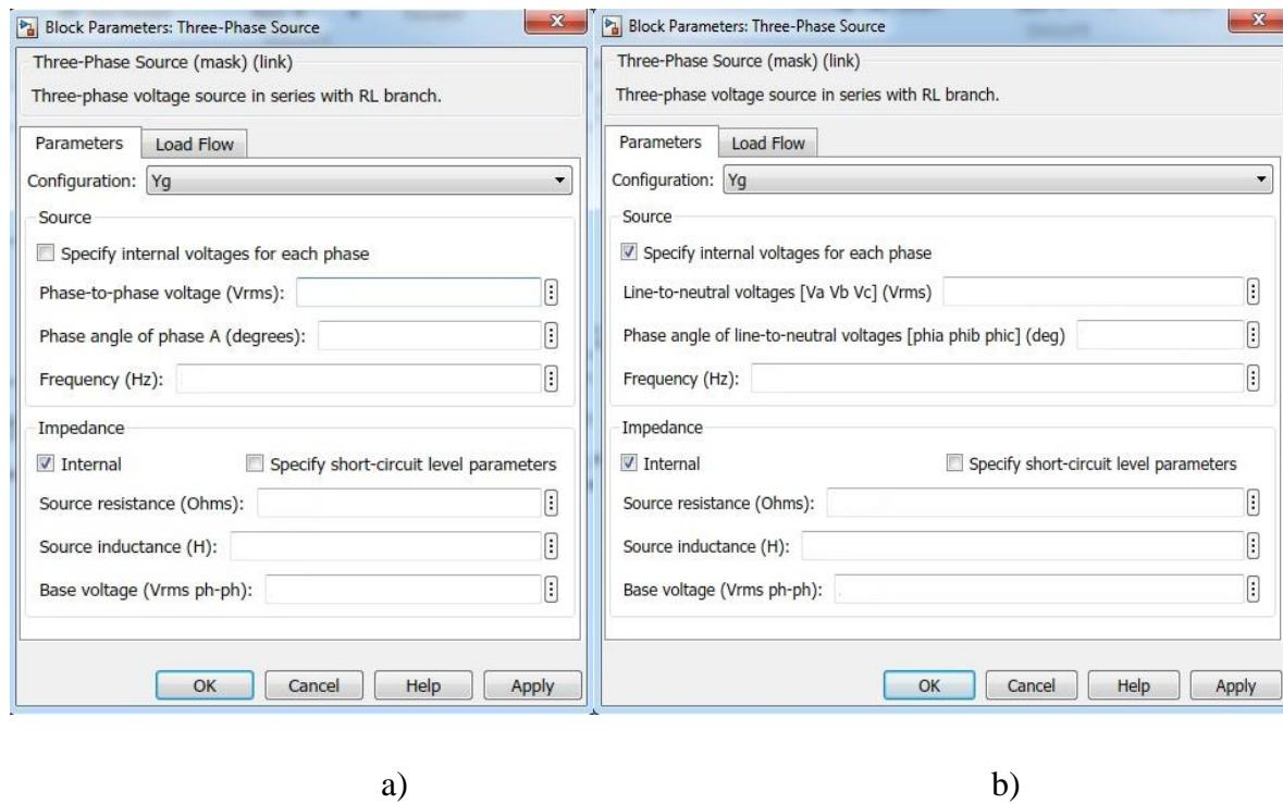
**Slika 5.3.** Blok za izravno parametriranje modela trofaznog izvora
