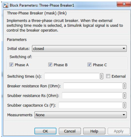
**Slika 5.13.** Blok za parametrisanje SN prekidača
