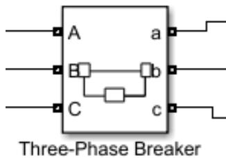
**Slika 5.12.** Model SN prekidača u Matlab – SimPowerSystemsu
