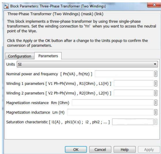
**Slika 5.11.** Blok za parametriranje veličina modela energetskog transformatora
