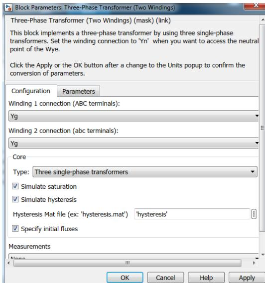
**Slika 5.10.** Blok za parametrisanje konfiguracije modela energetskog transformatora
