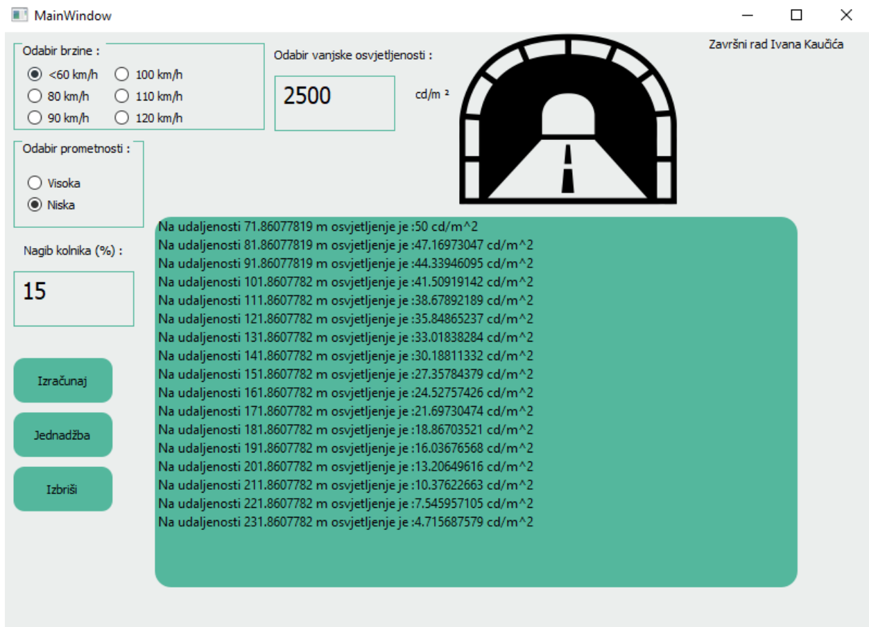
Slika 6.4. Prikaz pada osvjetljenja unutar tranzitne zone.
