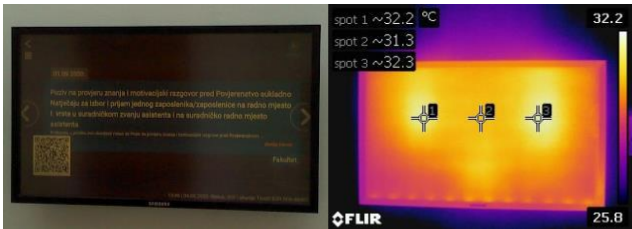
Slika 4.13. – Prikaz LCD LED televizora u vidljivom (lijevo) i infracrvenom (desno) spektru – rubno pozadinsko osvjetljenje.
