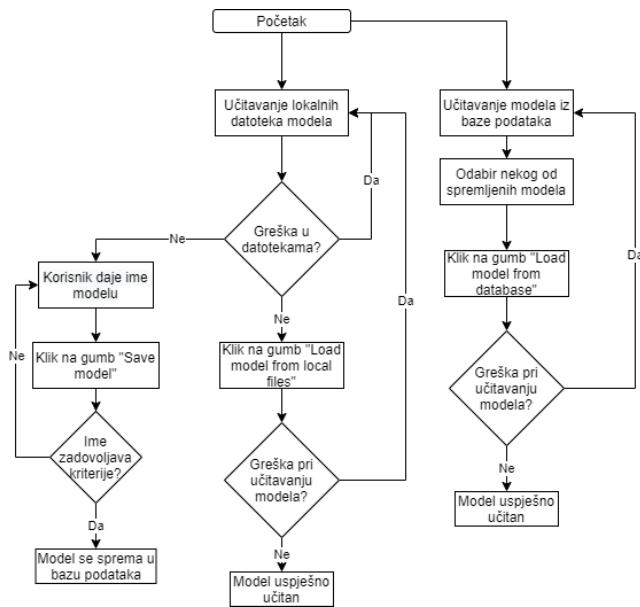
**Slika 5.40.** Dijagram toka stranice za ispitivanje vlastitih modela
