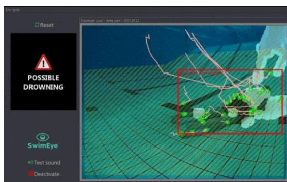
Slika 3.6. Detekcija potencijalnog utapanja koristeći SwimEye sustav [23]
