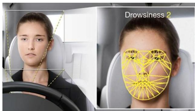
**Slika 3.8.** Sustav za detekciju pospanosti analizom izraza lica [28]
