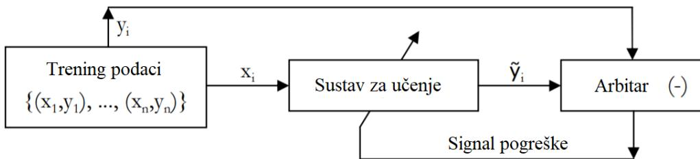
**Slika 2.1.** Blok dijagram koji prikazuje način nadziranog učenja [5]
