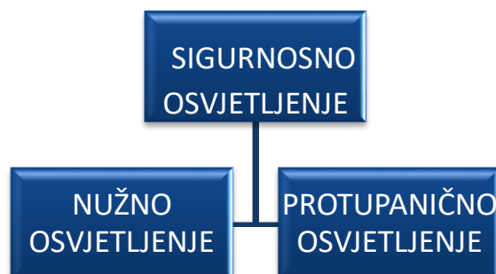
Slika 2.2. Podjela sigurnosnog osvjetljenja
