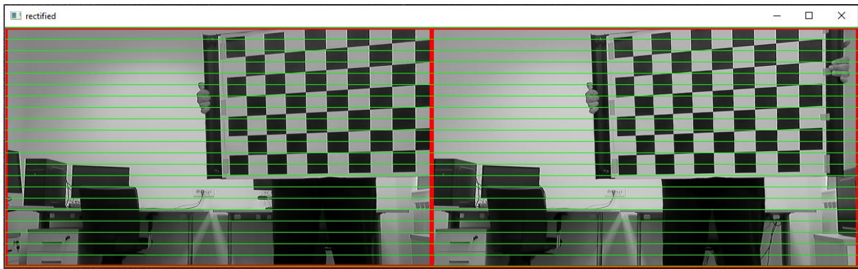
Sl. 3.6. Ispravljeni stereo par slika 3.4 i 3.5., s iscrtanim epipolarnim linijama.
