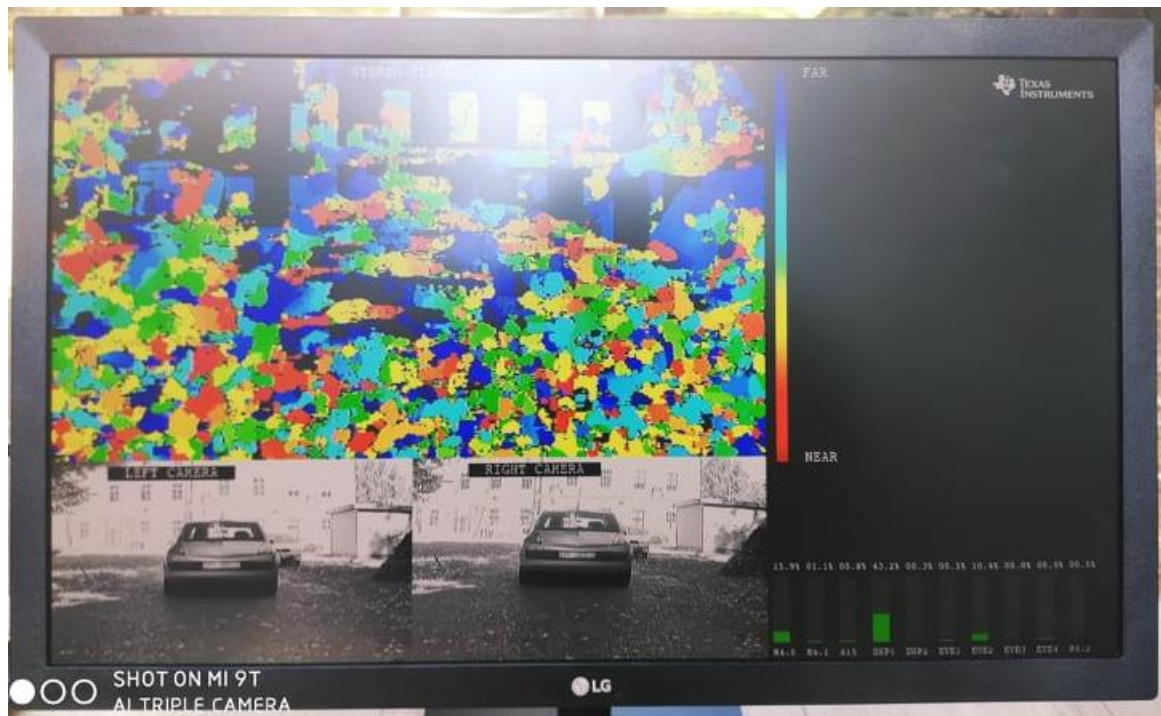
Sl. 3.8. Obojana disparitetna mapa prikazana s odgovarajućim ispravljenim parom video okvira.
