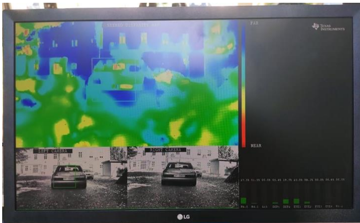
Sl. 3.13. Prikaz rješenja problema određivanja udaljenosti detektiranog vozila zasnovanog na korištenju stereo para slika, s implementiranim FGS filterom koji upotrebljava video okvir dobiven s lijeve kamere za navođenje.
