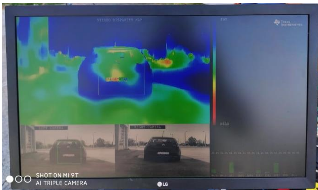
Sl. 4.7. Obojana disparitetna mapa rješenja zasnovanog na stereo paru slika, uz primjenu FGS filtera s navođenjem te ispravljeni stereo par slika s detektiranim drugim testnim vozilom, na udaljenosti od šest metara.
