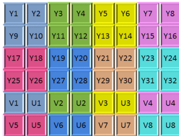
Sl. 3.4. Prikaz pod-uzorkovanja YUV420SP formata boje [21]
