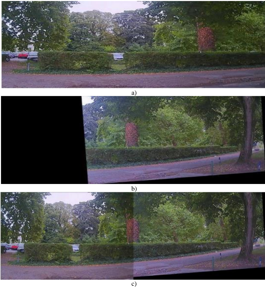
Sl. 3.23. Prikaz rezultat algoritma spajanja okvira: (a) srednji okvir za spajanje (b) desni transformirani okvir za spajanje (c) jedinstveno spojeni okvir
