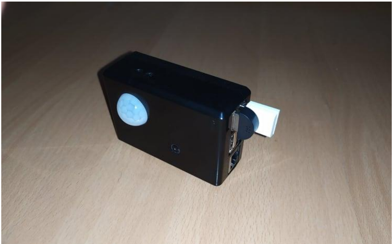
Slika 3.3. Gotova izvedba nadzornog sustava baziranog na Raspberry Pi računalu.
