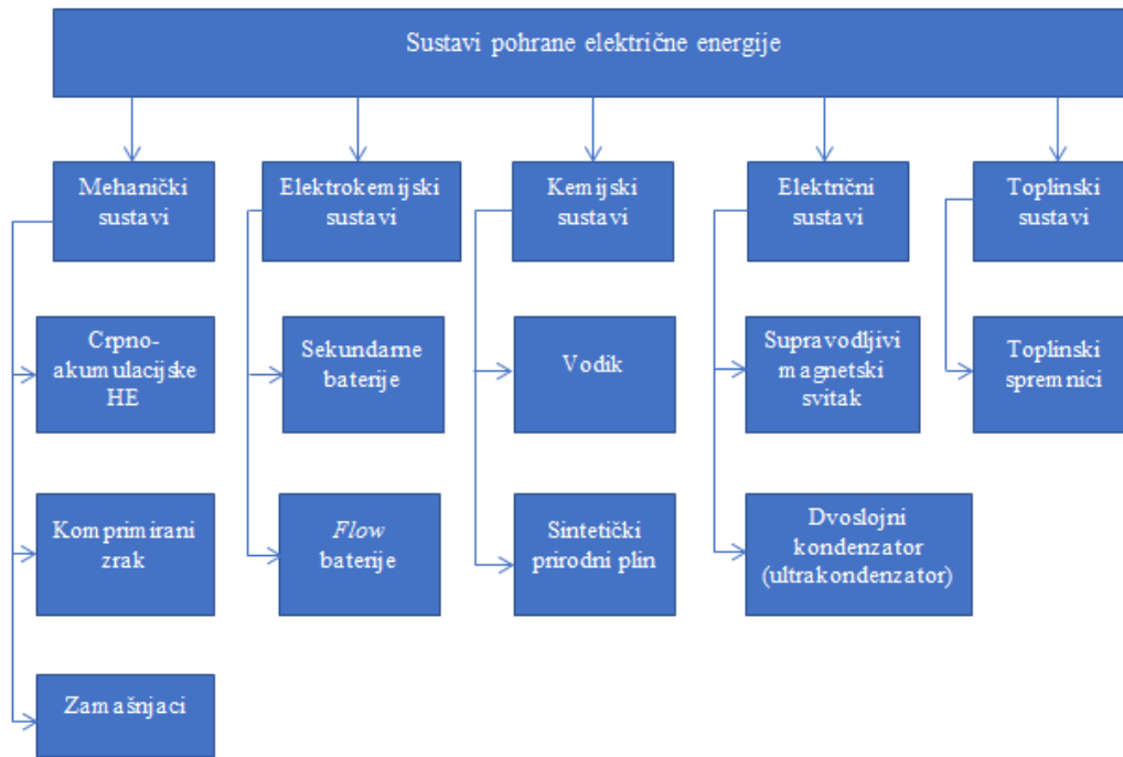
Slika 2.1. Sustavi pohrane električne energije [1]
