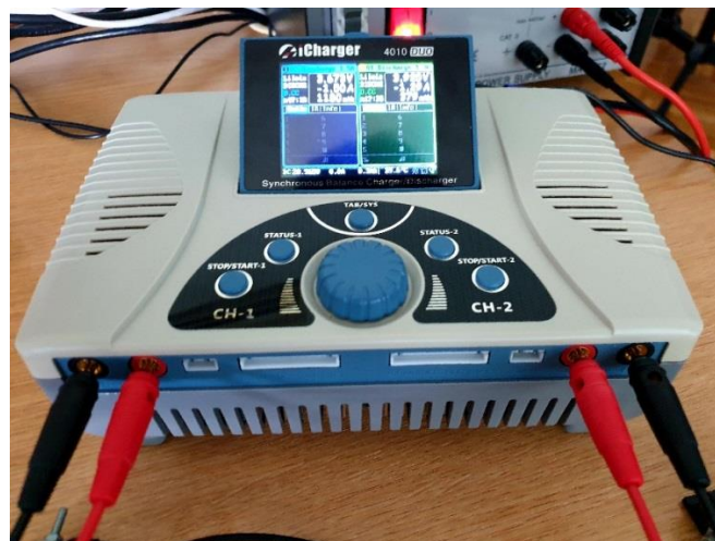
Slika 3.1. Uređaj Junsu iCharger 4010 Duo za punjenje/pražnjenje baterija
