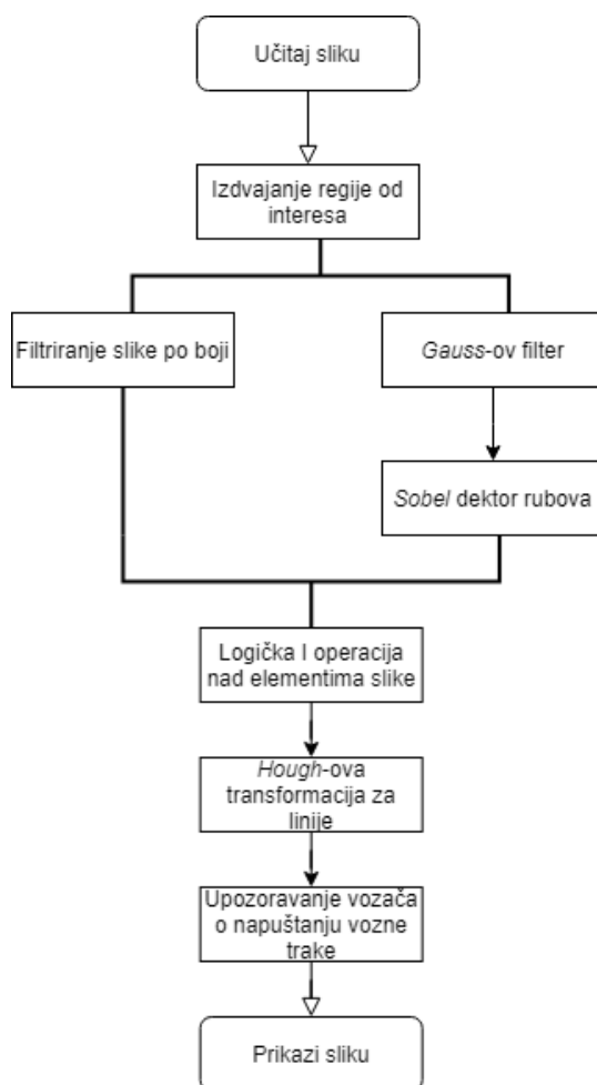
Slika 3.3. Blok prikaz algoritma za upozoravanje vozača o napuštanju vozne trake.
