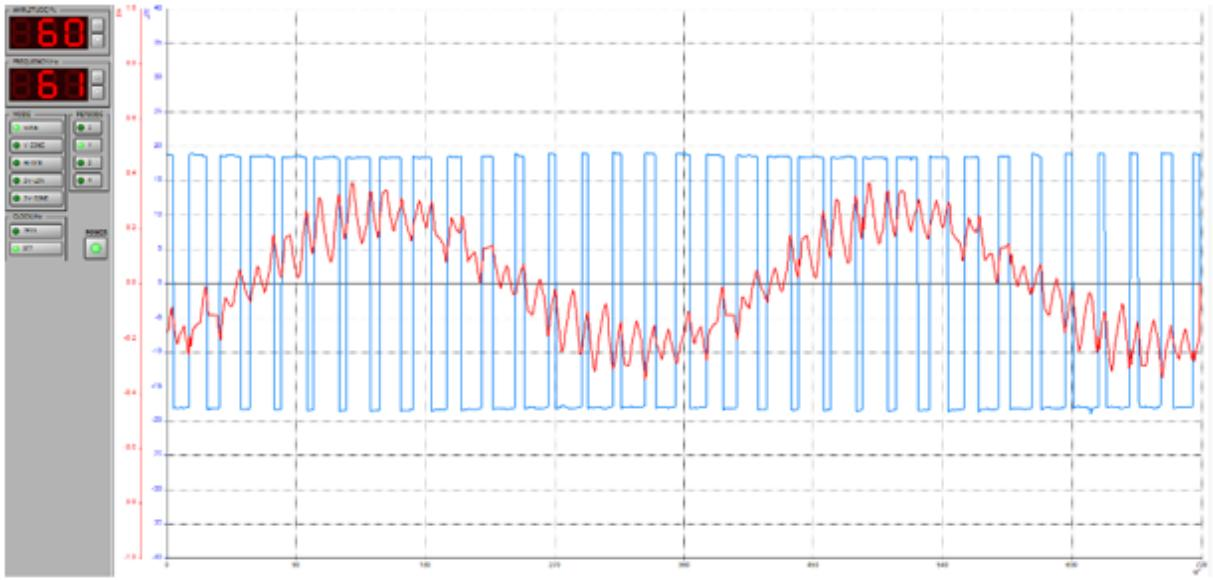
Slika 4.4. Prikaz faznog napona i fazne struje  $f=61 \text{ Hz}$ ;  $m_a= 60\%$ ,  $f_s=977 \text{ Hz}$  sinusna PWM modulacija. Izvor: Izrada autora
