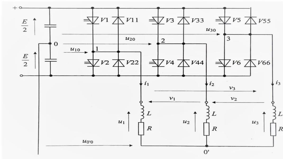
Slika 3.11 Shematski prikaz trofaznog izmjenjivača. Izvor: [4].
