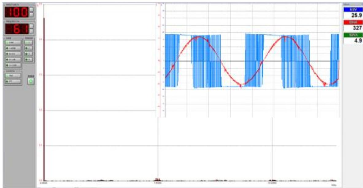
*Slika 4.10 LN – Starter, Harmonijski sadržaj struje  $f_{s2}=7810$  Hz,  $f=61$  Hz,  $m_a = 100\%$ .
