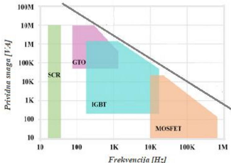
Slika 3.2. Ovisnost prijenosa snage o sklopnjoj frekvenciji komponente. Izvor: [6]
