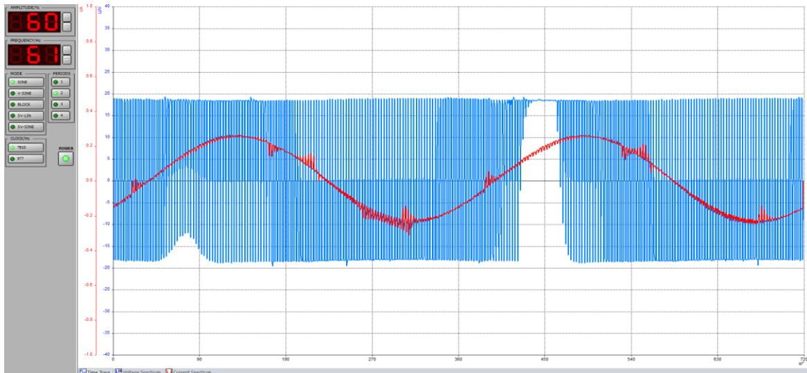
Slika 4.6. Prikaz faznog napona i fazne struje  $f=61$  Hz;  $m_a=60\%$ ,  $fs=7810$  Hz, sinusna PWM.
