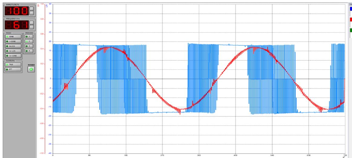
Slika 4.7. Prikaz faznog napona i fazne struje  $f=61$  Hz;  $m_a=100\%$ ,  $fs=7810$  Hz sinusna PWM.
