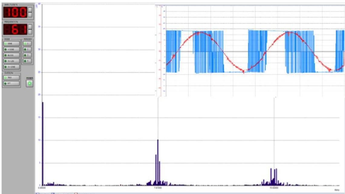
Slika 4.9. LN – Starter, Harmonijski sadržaj napona  $f_{s2}=7810$  Hz,  $f=61$  Hz,  $m_a = 100\%$ . Izvor: Izrada autora.
