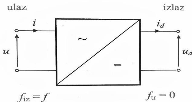
Slika 3.7. Simbol jednofaznog ispravljača i referentni smjerovi napona i struja na priključnicama. Izvor: [4].
