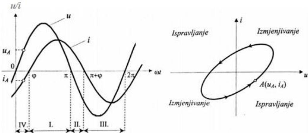
Slika 3.10 Prikaz režima rada autonomnog izmjenjivača. Izvor: [7]
