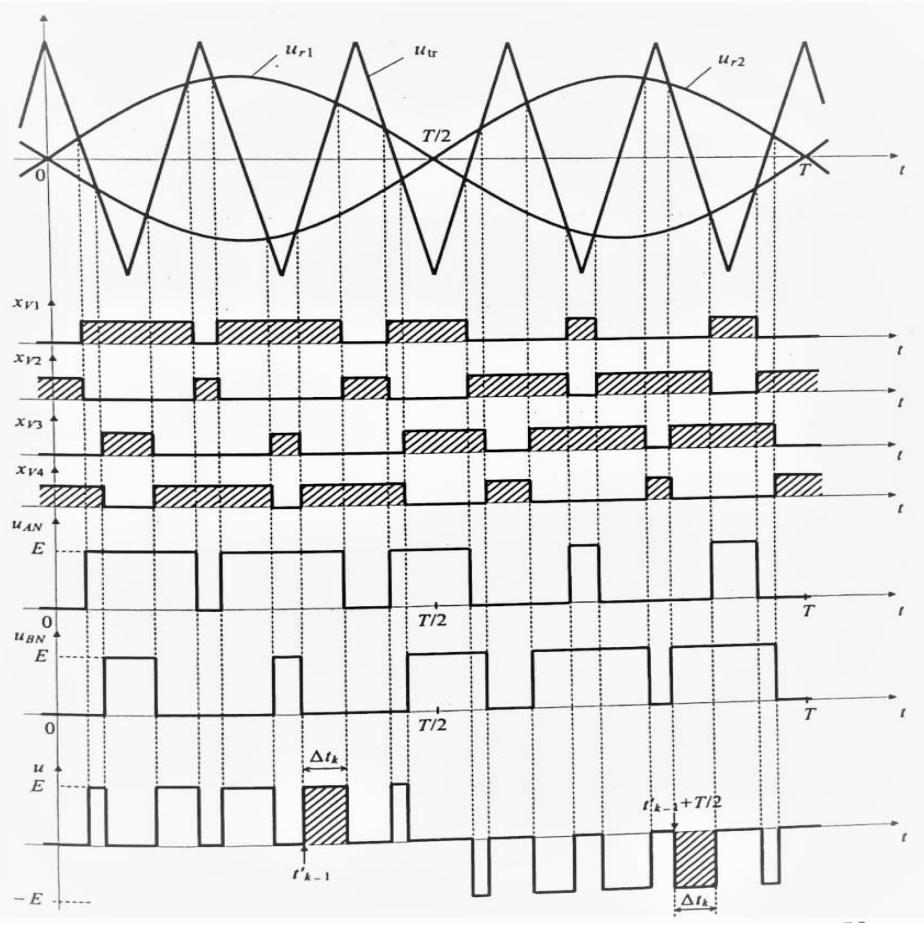
Slika 3.12 Karakteristični valni oblici napona i upravljačkih signala. Izvor: [4]
