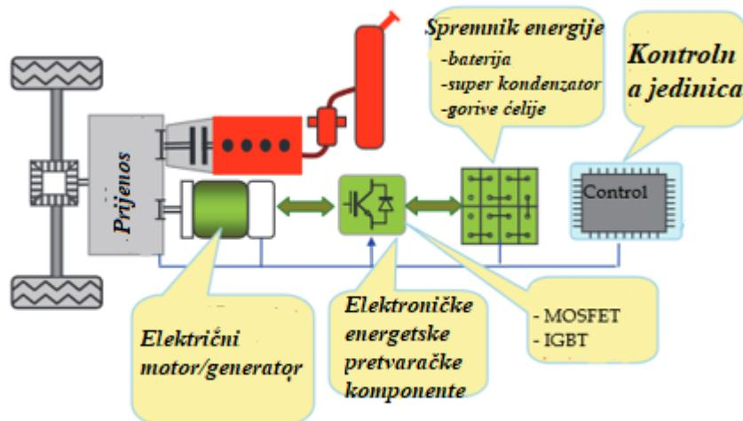
Slika 1.1. Prikaz blok sheme hibridnog vozila. Izvor: [1].
