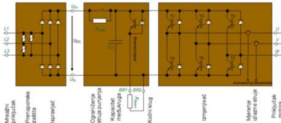
Slika 2.1. Prikaz strukture frekvencijskog pretvarača. Izvor: [2].
