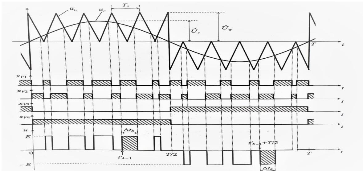
Slika 2.5. Prikaz presijecanja upravljačkog i referentnog signala. Izvor:[4]
