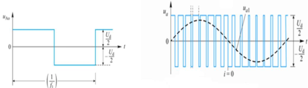
Slika 2.3. Lijevo: valni oblik napona pravokutne modulacije, desno: valni oblik napona PWM.
