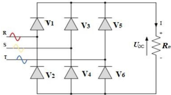
Slika 3.8. Shematski prikaz neupravljivog trofaznog ispravljачa. Izvor: [4]
