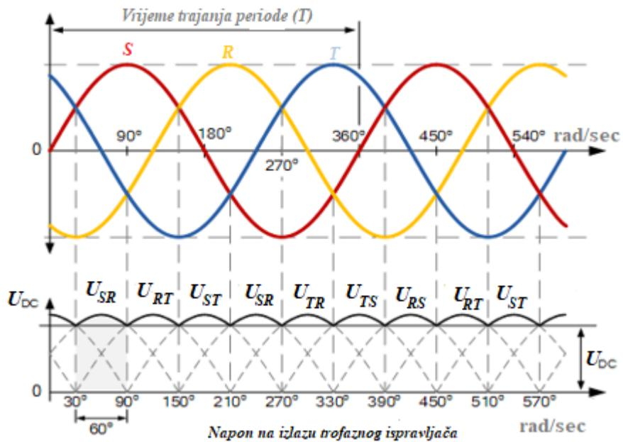
Slika 3.9. Prikaz napona na trošilu trofaznog neupravljivog ispravljачa. Izvor: [4]
