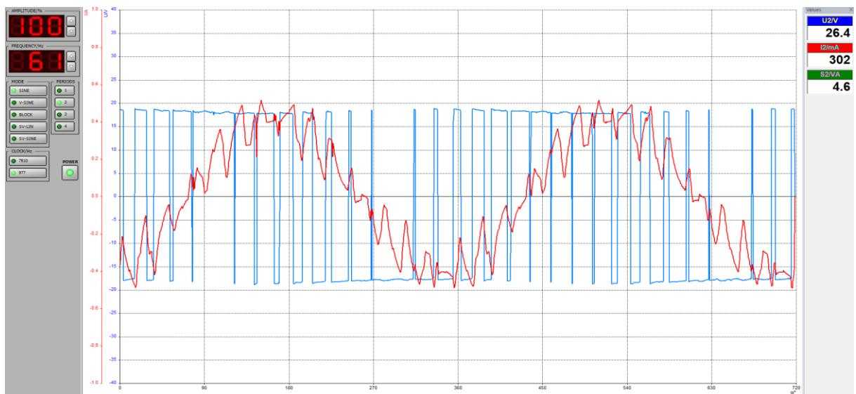
Slika 4.5. Prikaz faznog napona i fazne struje  $f=61 \text{ Hz}$ ;  $m_a= 100\%$ ,  $f_s=977 \text{ Hz}$  sinusna PWM modulacija. Izvor: Izrada autora.
