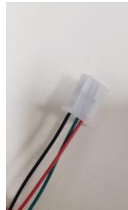
Slika 3.8 Kontakti za spajanje ručke gasa kontrolera HS4842580
