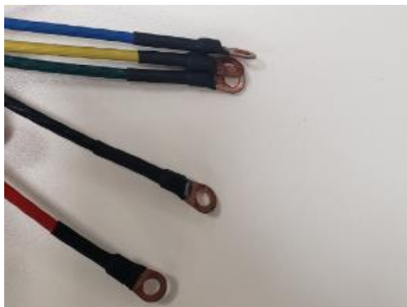
Slika 3.3 Spojnice za spajanje baterije i elektromotora po fazama kontrolera HS4842580
