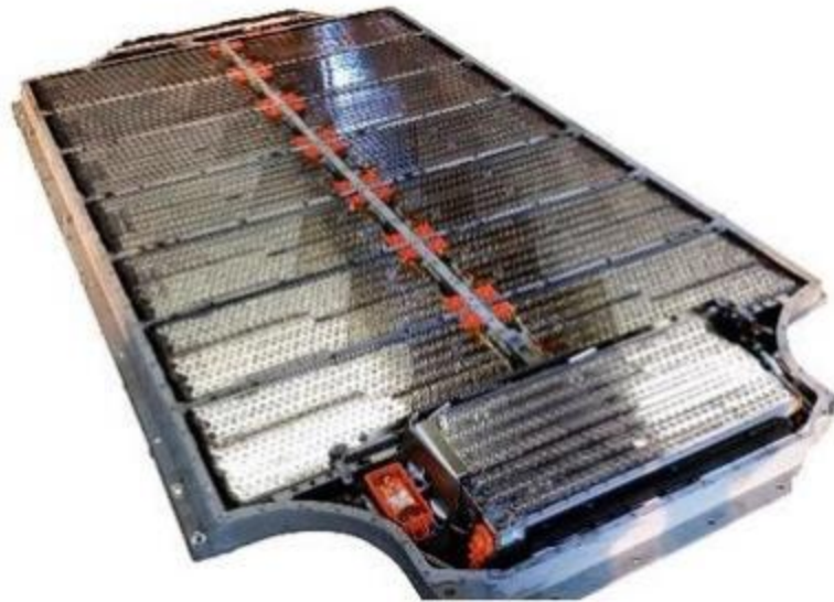
Slika 2.24 Arhitektura baterijskog sloja Tesla Model S [27]
