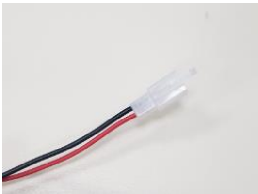
Slika 3.17 Kontakti za dodatno napajanje kontrolera HS4842580
