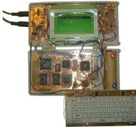
Slika 2.4. Industrijsko ugradbeno računalo [6]
