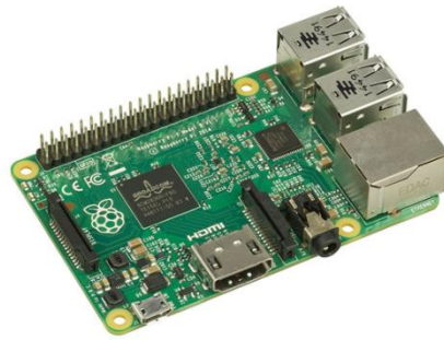
Slika 2.3. Industrijsko single-board računalo [5]
