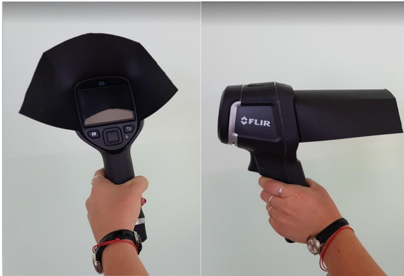
Slika 5.6. Zasjenjene zaslona kamere crnim papirom
