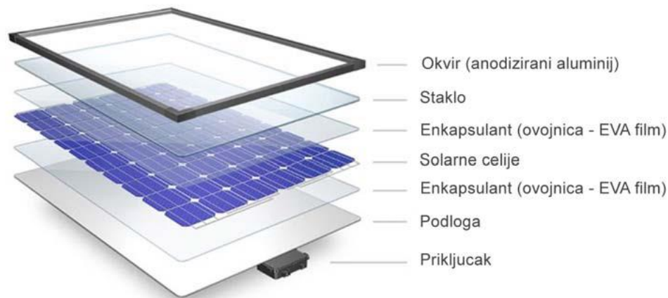
Slika 4.2.1. Struktura fotonaponske ćelije, izvor [10]
