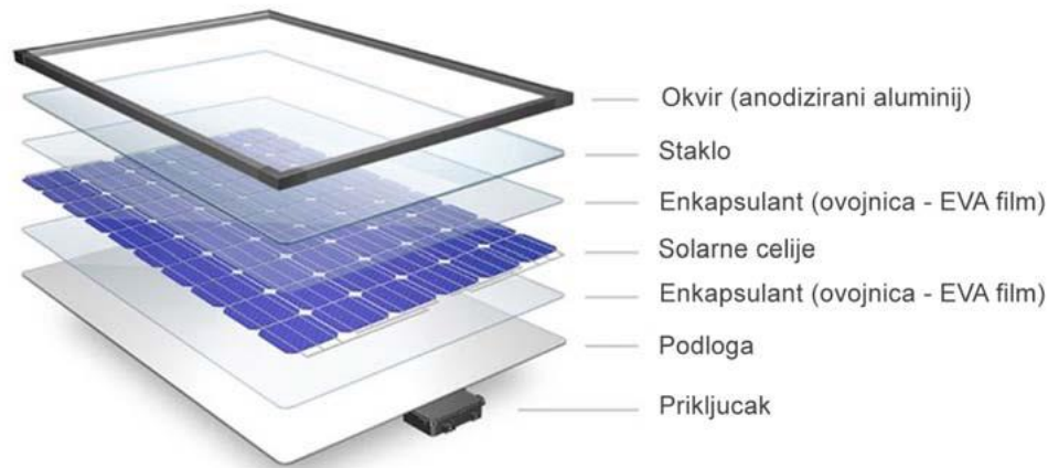
Slika 4.2.1. Struktura fotonaponske ćelije, izvor [10]
