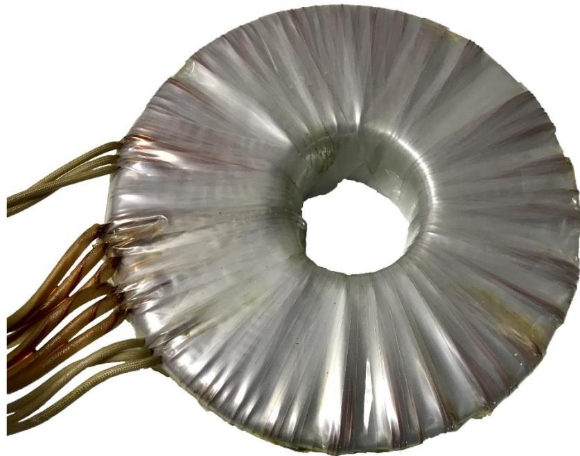
**Slika 2.2.** Jednofazni dvonamotni toroidni transformator korišten u istraživanju.
