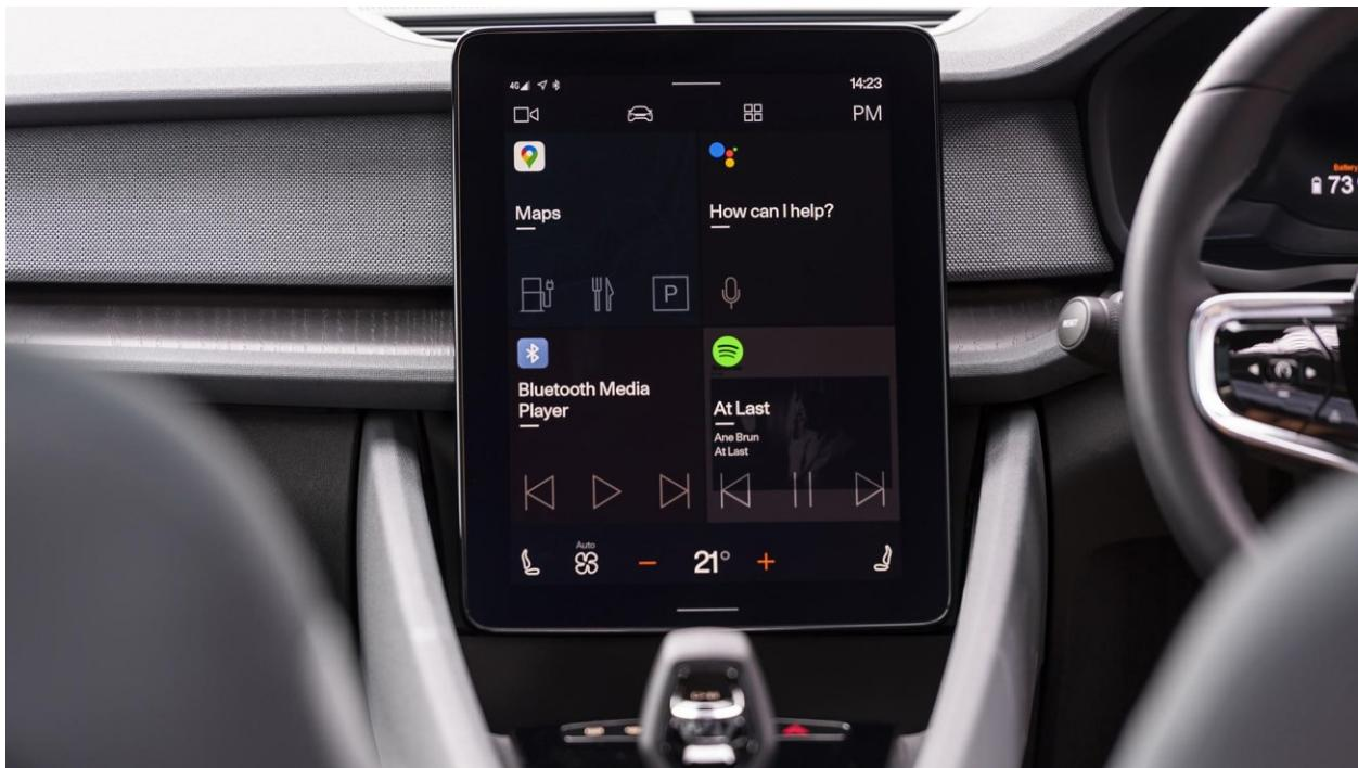
Slika 3.5. Izgled sučelja Android Automotive operacijskog sustava
