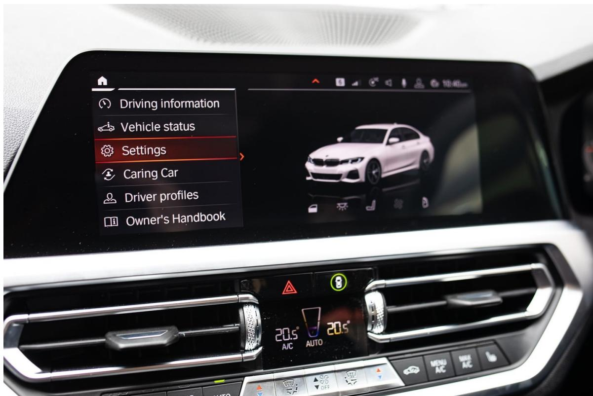
Slika 4.1. Izgled osnovanog sučelja iDrive informacijsko-zabavnog sustava
