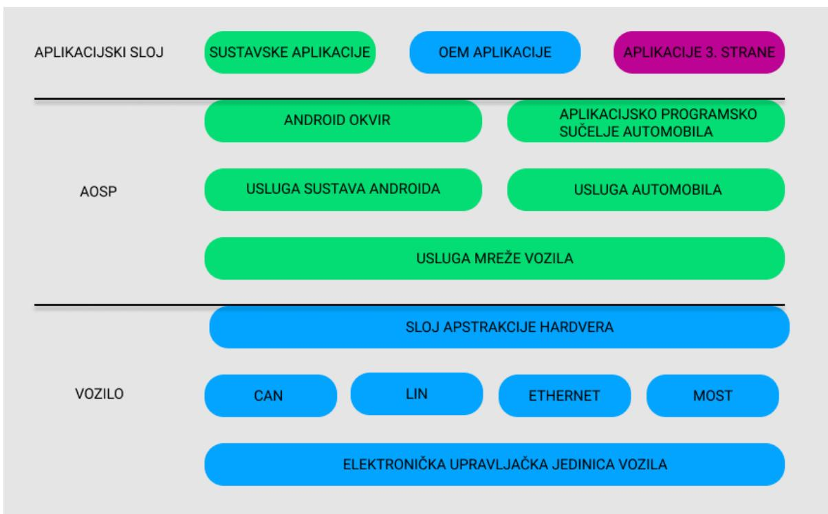
**Slika 3.2.** Arhitektura HAL-a i Android Automotive operacijskog sustava
