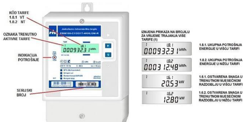
Slika 2.2.1. Elektroničko (digitalno) brojilo [6].
