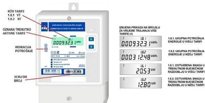
Slika 2.2.1. Elektroničko (digitalno) brojilo [6].
