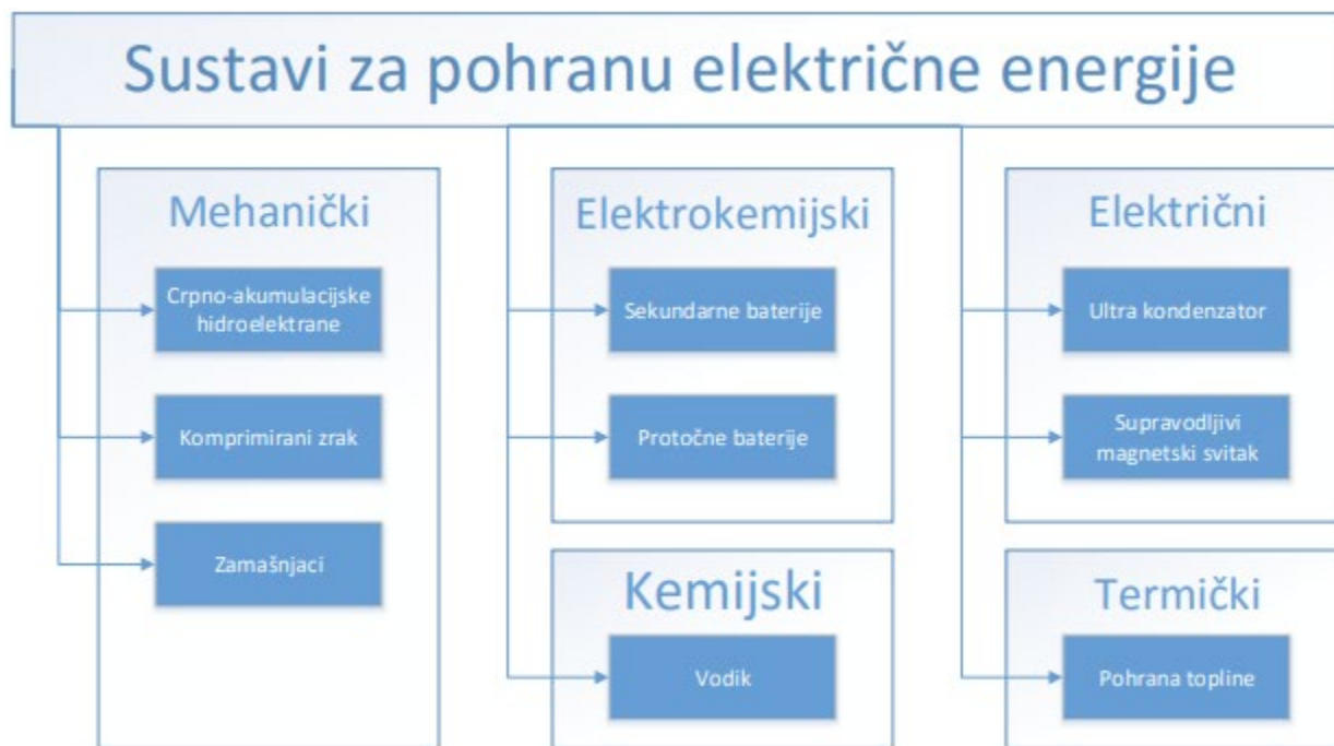
Slika 3.2: Podjela sustava za pohranu električne energije po obliku energije u koje se električna energije pretvori [10]
