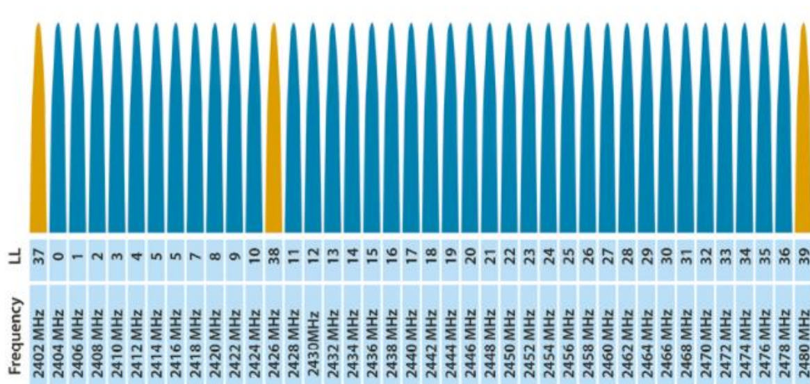
Slika 5.1. Distribucija kanala kod BLE standarda [15]
