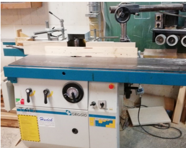
Slika 3.14. Stolna glodalica „Griggio T45i“ (fotografirano 18.4.2018.)
