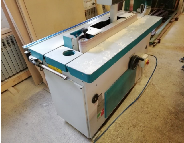
Slika 3.12. Vertikalna tračna brusilica (fotografirano 18.4.2018.)
