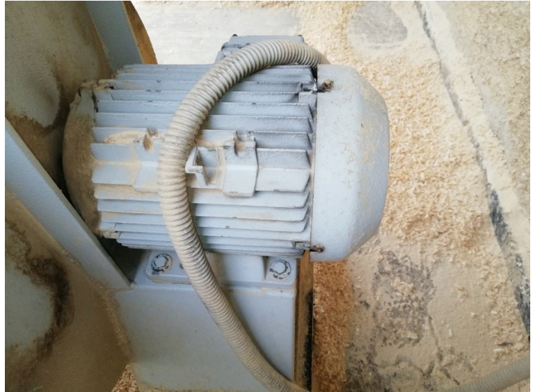
Slika 3.3. Pogonski motor ciklona (fotografirano 18.4.2018.)
