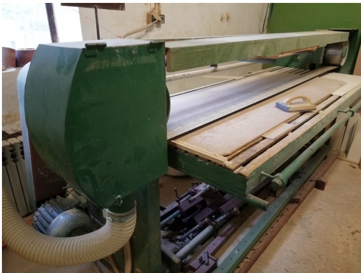
Slika 3.10. Horizontalna tračna brusilica (fotografirano 18.4.2018.)
