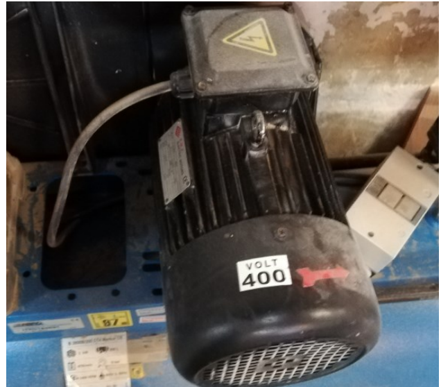
Slika 3.5. Pogonski motor kompresora (fotografirano 18.4.2018.)
