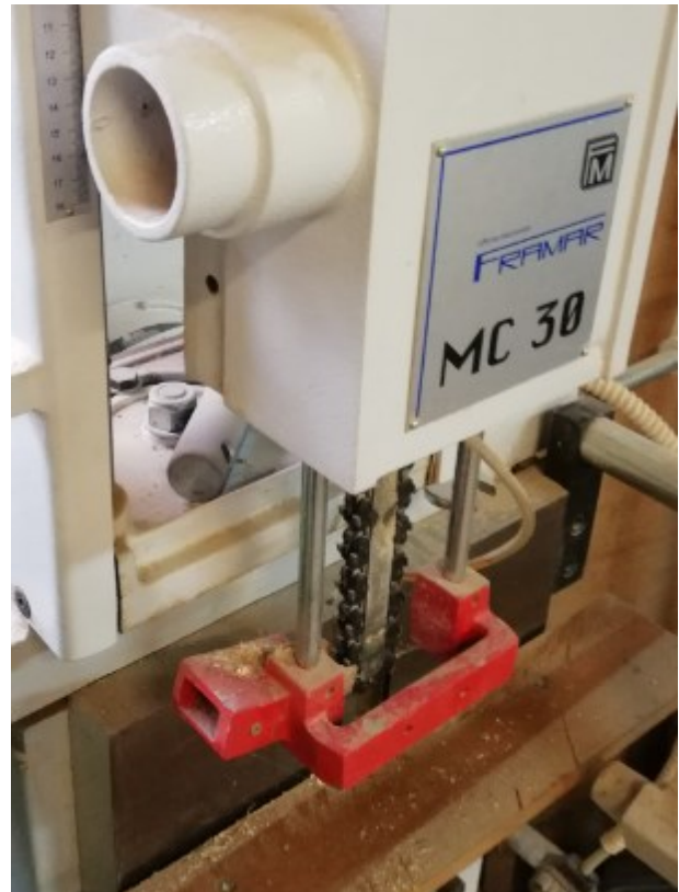
Slika 3.7. Radna površina i pila dubilice (fotografirano 18.4.2018.)
