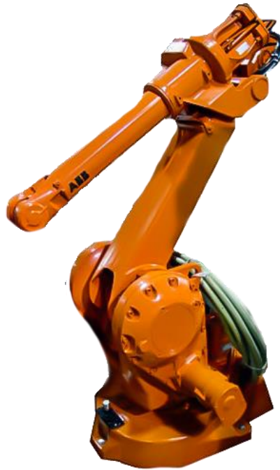
Slika 4.2: Robotski manipulator ABB-IRB 2400L [36]
