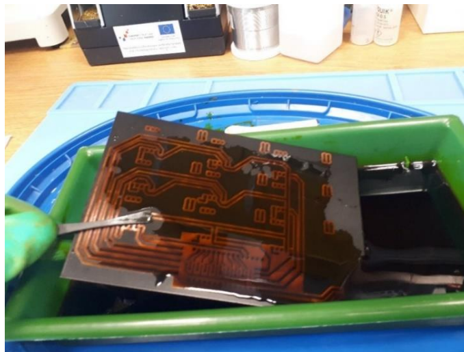
Slika 3.6. Postupak skidanja bakar pomoću feriklorid kiseline
