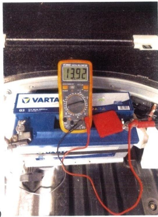
Slika 2.2.3 . Napon akumulatora u stanju mirovanja ( slika a),napon akumulatora pri pokretanju (slika b),napon akumulatora nakon u.staljenog slanja(slika c)
