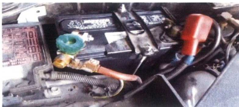
Slika 3.3.1. Ugradnja prekidača za automobilski akumulator
