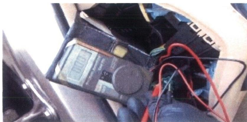
*Slika 4.1.3. Ispitivanje pada napona voltmetrom preko osigurača (Mercedes E 220)*
