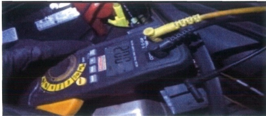
Slika 4.1.2. Struja parazitne potrošnje 20mA(Mercedes E 220)
