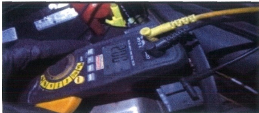
Slika 4.1.2. Struja parazitne potrošnje 20mA(Mercedes E 220)
