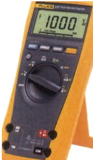
Slika 3.2.1. Digitalni multimetar Fluke 177, izvor [13]
