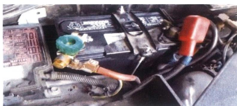
*Slika 3.3.1. Ugradnja prekidača za automobilski akumulator*
