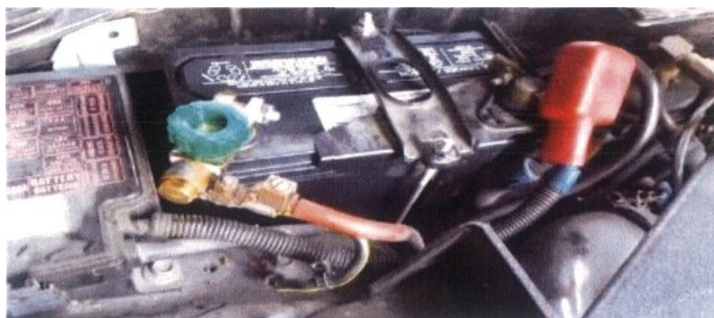
Slika 3.3.1. Ugradnja prekidača za automobilski akumulator
