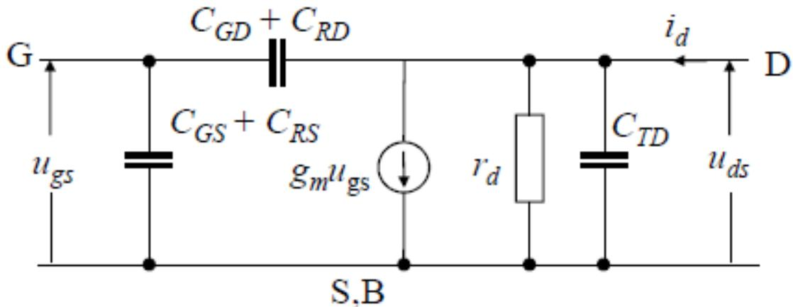
Slika 2.9 Nadomjesni spoj za visoke frekvencije [5]
