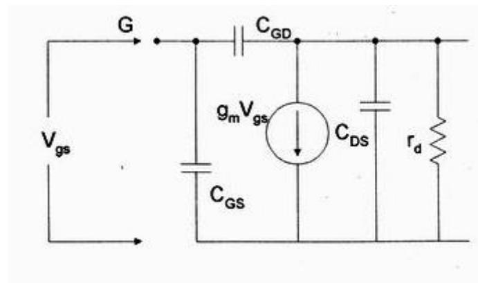
Slika 2.5 Nadomjesni sklop za visoke frekvencije. [9]
