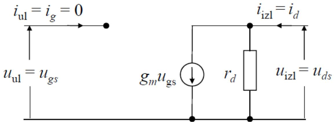
Slika 2.4 Nadomjesni sklop za niske frekvencije [6]
