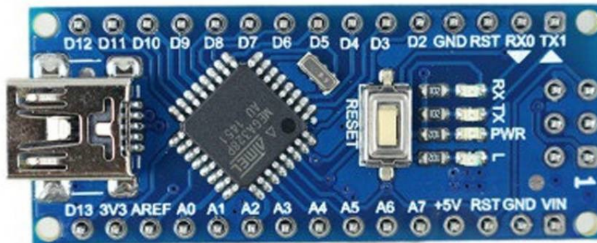
Slika 3.3. Arduino Nano sa svim svojim ulazima i izlazima [9].
