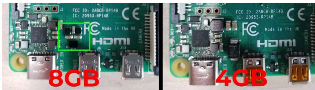
Slika 3.2. Razlika između napajanja na modelima s 4GB i 8GB RAM-a [8].
