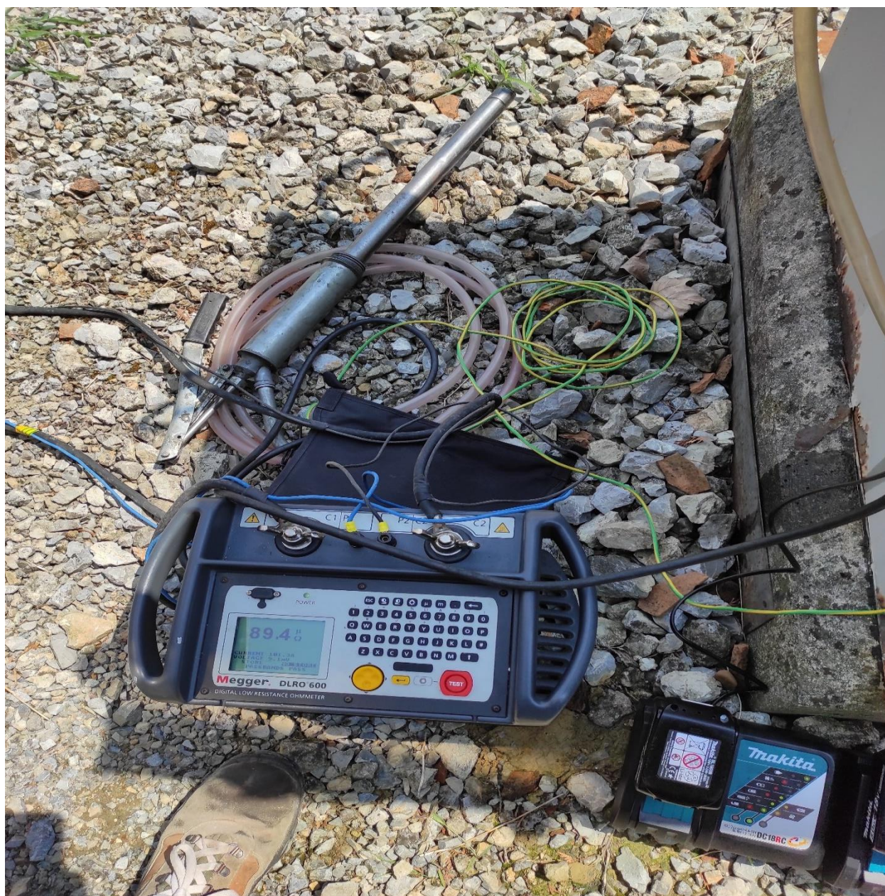
Slika 5.5. Uređaj za mjerenje padova napona na primarnim spojevima Megger DLRO 600
