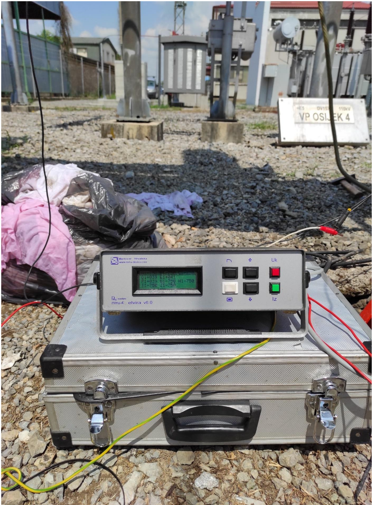
Slika 5.4. Uređaj za mjerenje vremena uklopa i isklopa prekidača Elvira v6.0
