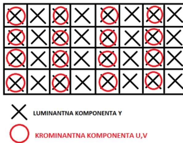
Slika 3.4. Shema poduzorkovanja YUV 4:2:2
