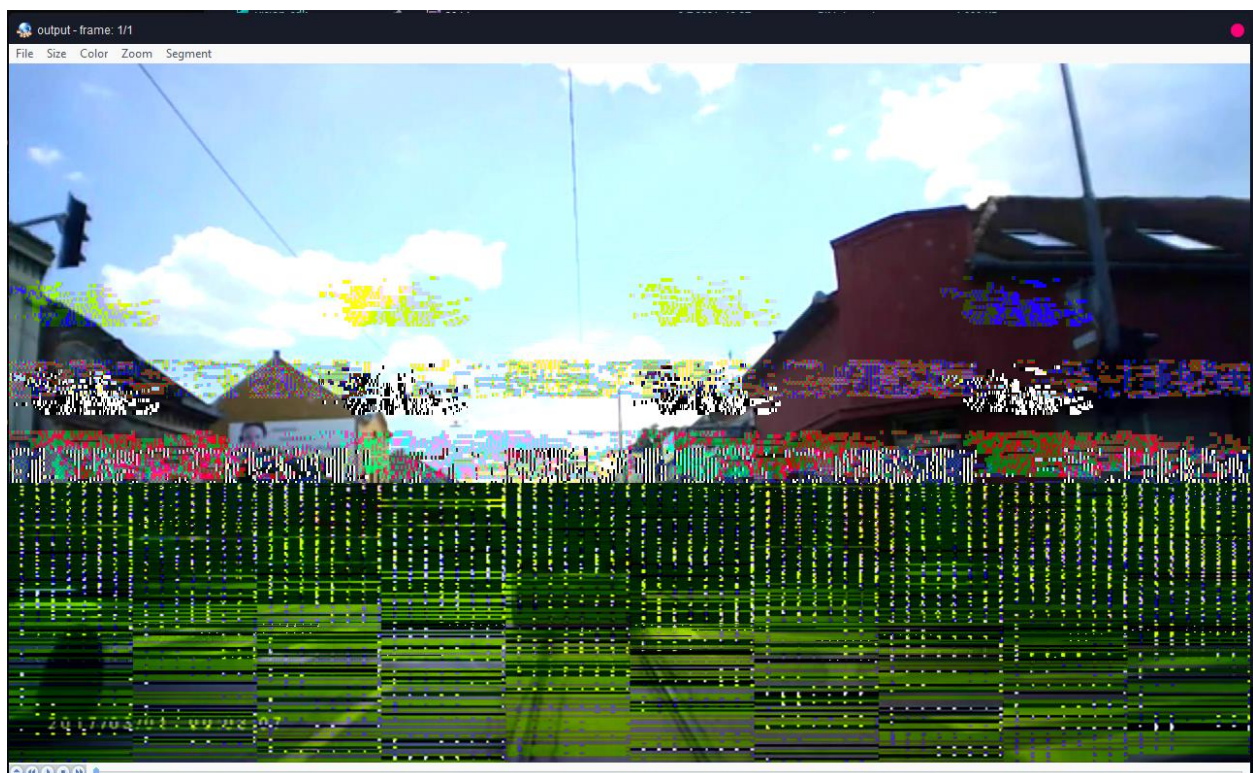
Slika 4.23. Primjer lošeg rezultata bikubične interpolacije prilikom istovremenog korištenja procesora A15, DSP1 i DSP2; Slika prikazuje slučajne vrijednosti iz memorije
