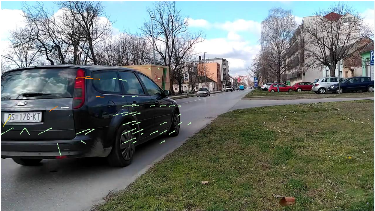
Slika 4.14. Primjer iscrtanih, netočno grupiranih, VP iz niza mirna kamera rezolucije 1280x720 elemenata slike uz makroblok 32x32 elementa slike metode EBMA a) zbog nepronađenih VP, b) zbog previše netočno pronađenih VP.
