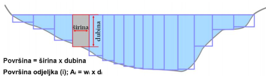
Slika 6.1.3. Određivanje površine odjeljaka [25]
