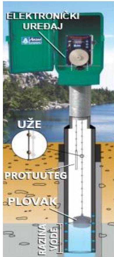
Slika 3.1.1. Princip rada i dijelovi elektroničkog limnografa s plovkom [14]
