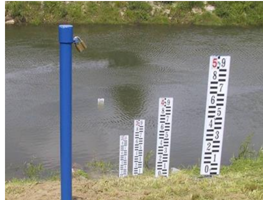
Slika 3.2. Vodomjerne letve na kosom terenu [2]
