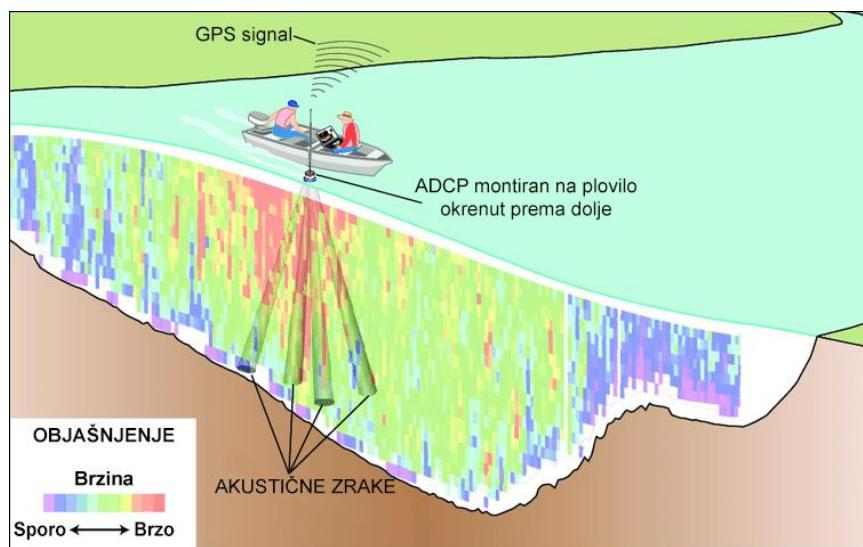
Slika 5.2.3. Objašnjjenje metode mjerena brzine vode ADCP-om [32]
