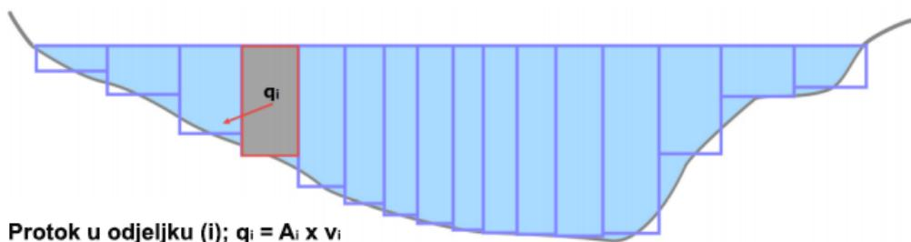
Slika 6.1.5. Izračunavanje protoka za svaki pojedini odjeljak [25]
