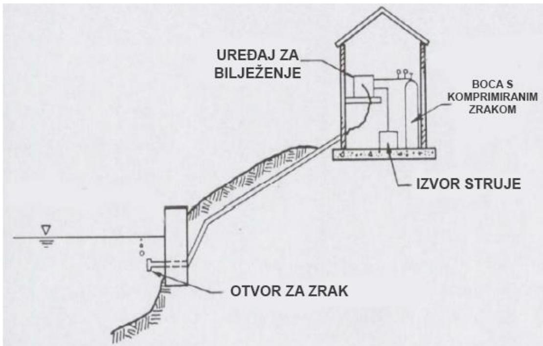
Slika 3.2.1. Princip rada i dijelovi tlačnog limnigrafa [41]
