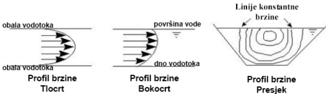
Slika 5.2. Profili brzine vode na vodotoku [5]
