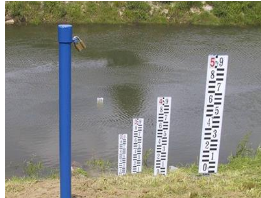
Slika 3.2. Vodomjerne letve na kosom terenu [2]
