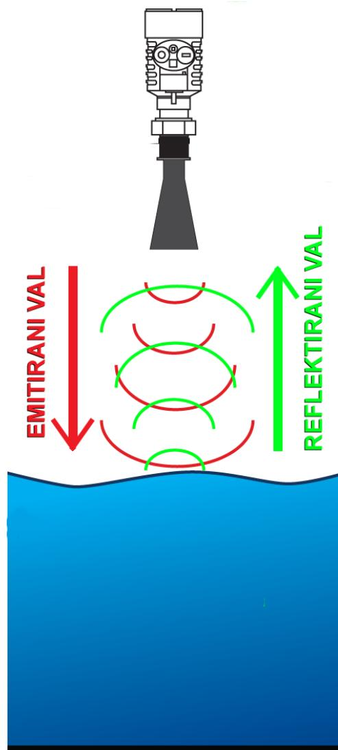
Slika 3.3.1. Princip rada radarskog senzora [16]
