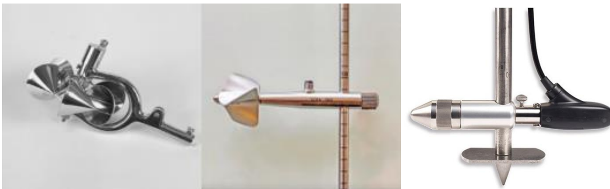
Slika 5.1.2. Vrste mjerila brzine strujanja vode (s čašicama, s propelerima, elektromagnetsko) [31]
