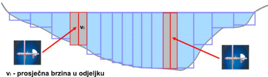
Slika 6.1.4. Određivanje prosječnih brzina po odjeljcima [25]
