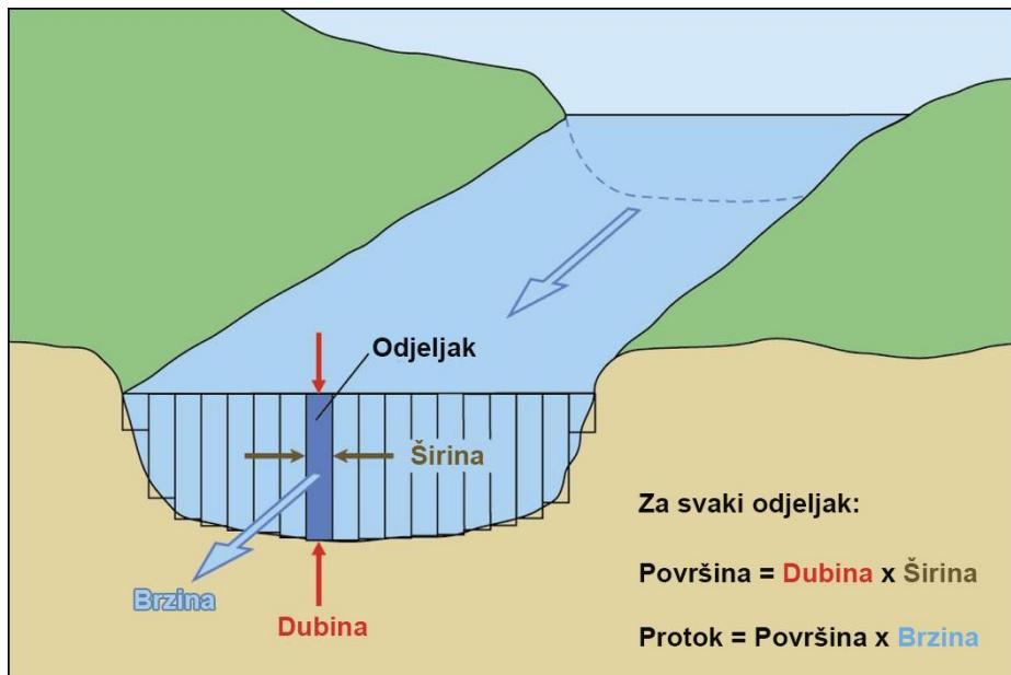
Slika 6.1.1. Poprečni presjek s rasporedom vertikala [25]
