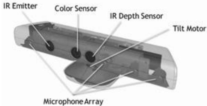
*Slika 2.3. Prikaz Kinect senzora sa označenim dijelovima*
