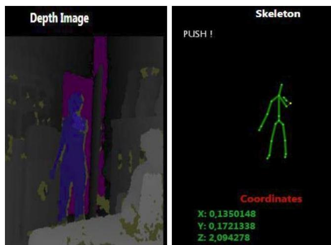
*Slika 2.5. Prikaz prepoznavanja geste guranja putem Kinect senzora*
