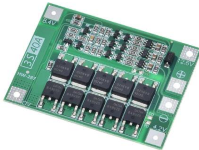
Slika 4.1. Primjer BMS-a na Li-Ion bateriji [17]
