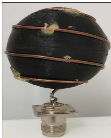
Sl. 3.6. Izvedba loksodromske antene sa podlogom ( D=6\text{cm} , N=4\text{cm} )
