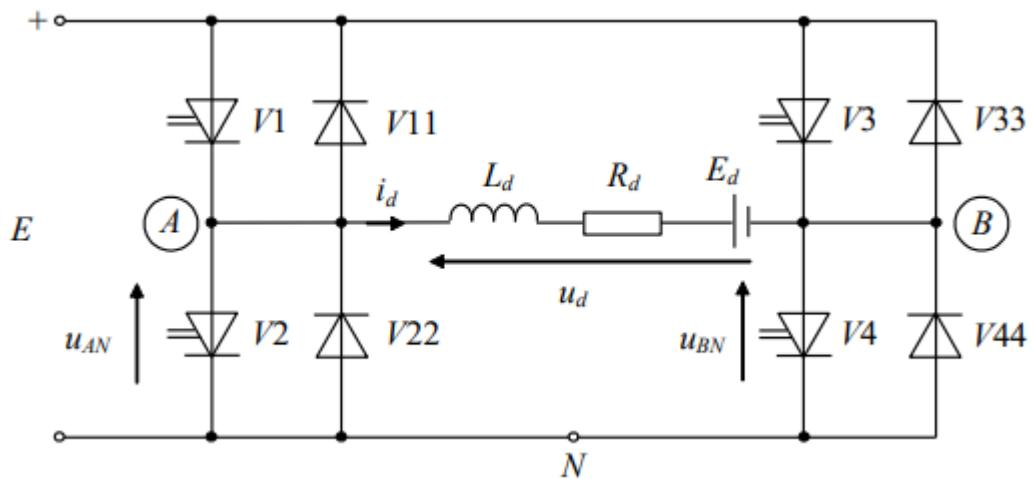
Slika 4.1. Četverokvadrantni pretvarač u konfiguraciji mosnog spoja [1].
