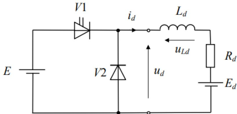
Slika 4.8. Shema silaznog pretvarača u kontinuiranom režimu rada koji napaja aktivno trošilo [1].
