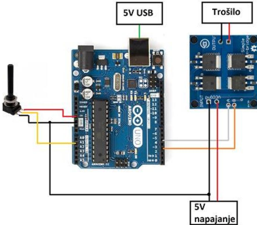
Slika 3.8. Shema spajanja Arduina Una sa potenciometrom i sklopom mosnog spoja.
