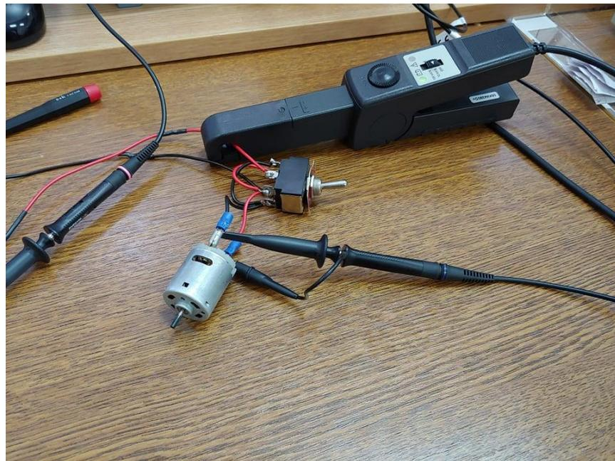
Slika 3.9. 12V istosmjerni motor spojen sa kip prekidačem.
