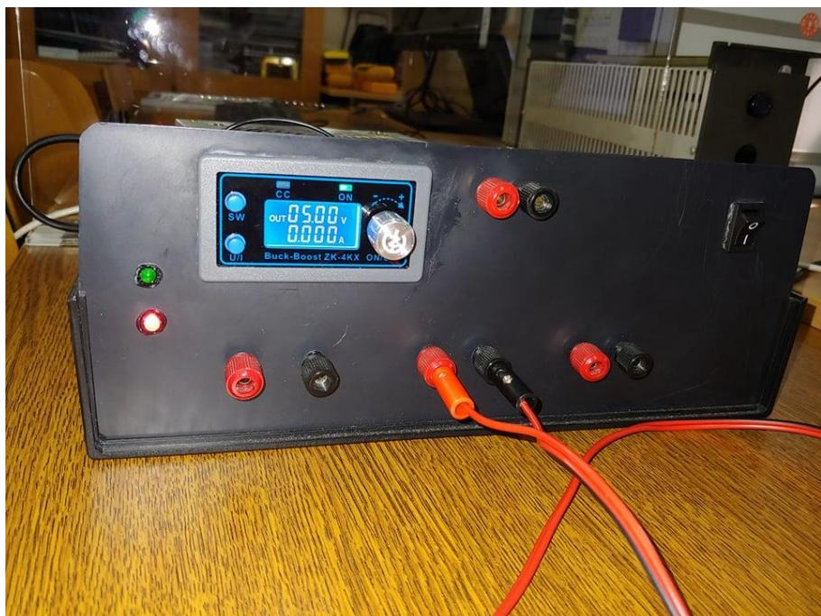
Slika 3.4. Prikaz napajanja s izlaznim naponom od 5V.
