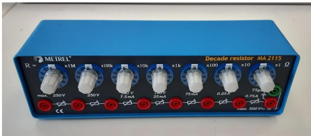
Slika 4.1. Promjenjivi otpornik
