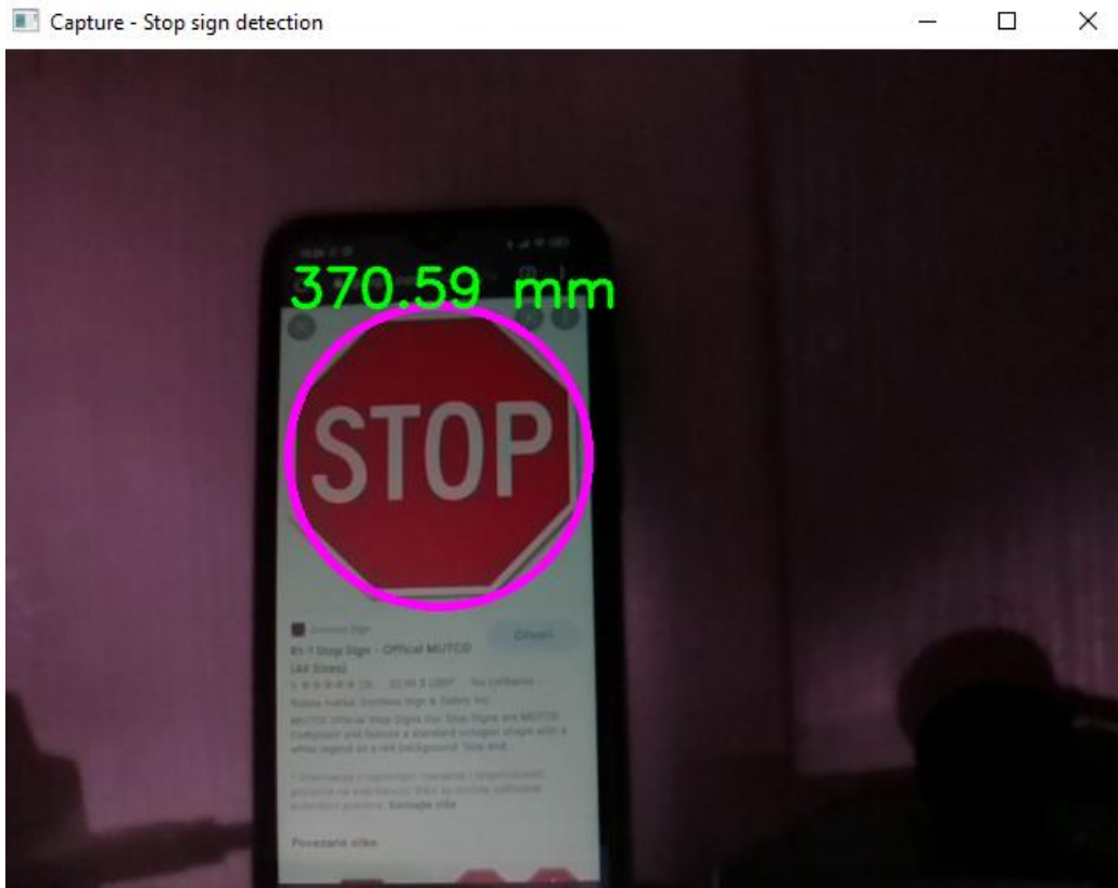
Slika 3.20 Obradena slika gdje je prepoznat objekt te udaljenost od istog
