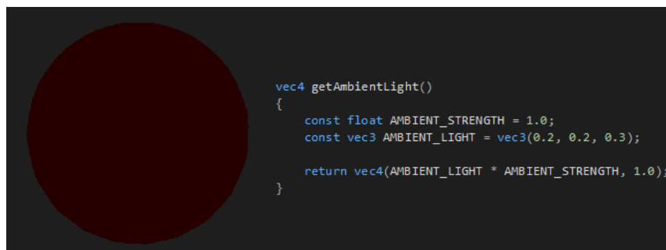
Slika 4.6. Prikaz i implementacija ambijentalnog osvjetljenja na modelu sfere
