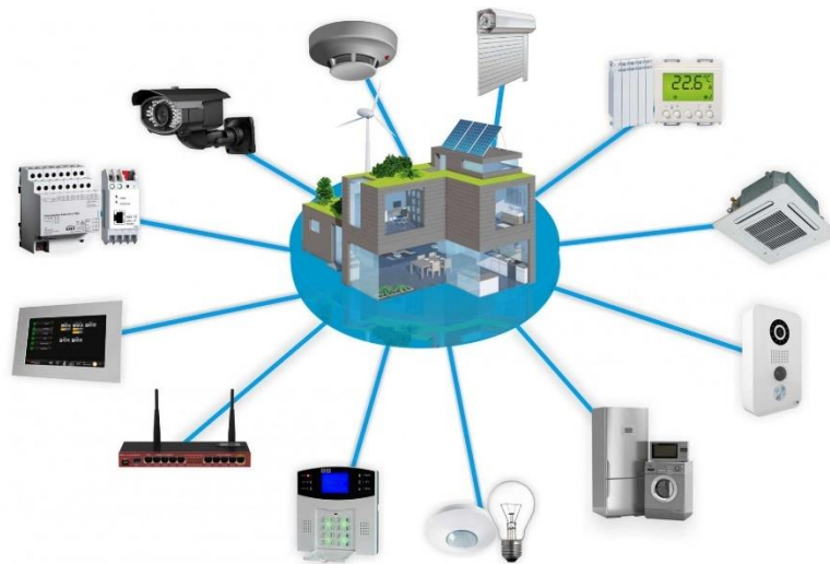
Slika 3.1. Prikaz uređaja upravljivih KNX standardom.
