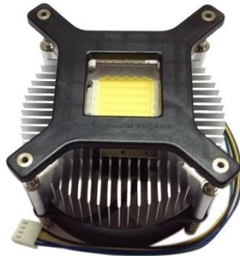
Slika 2.5. Primjer LED postavljene na dodatni hladnjak s ventilatorom.
