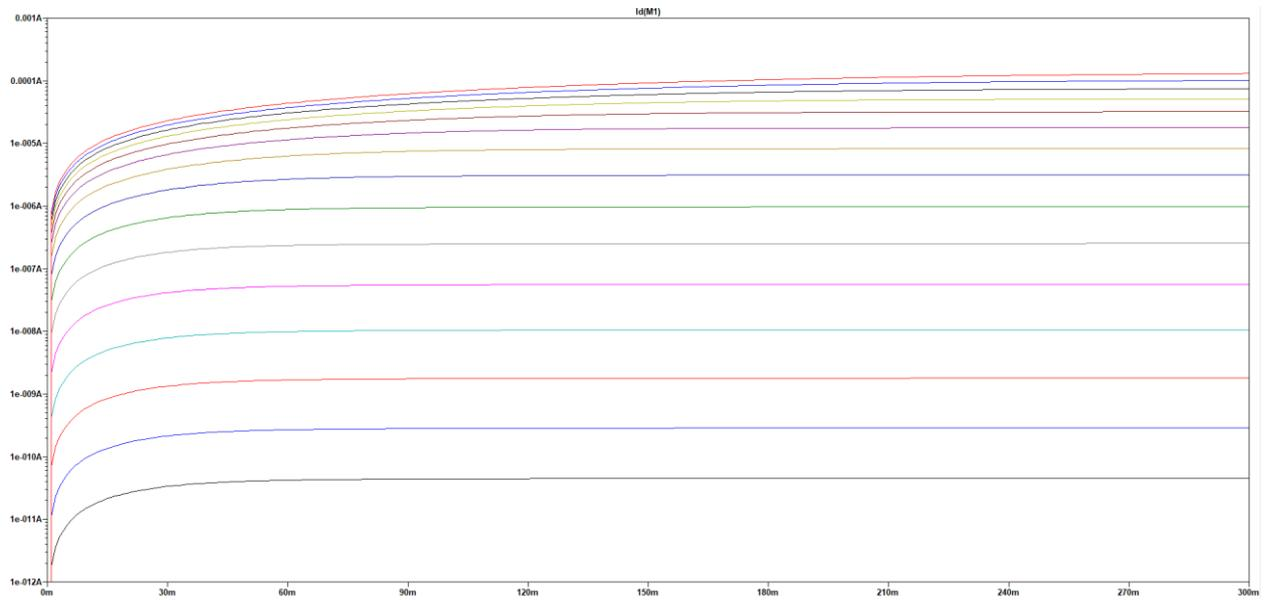
Sl. 6.7. Simulacija  $I - U$  karakteristika tsmc180n modela
