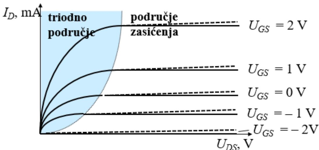
Sl. 3.2.  $I - U$  karakteristike N - kanalnog osiromašenog MOSFET-a [1]
