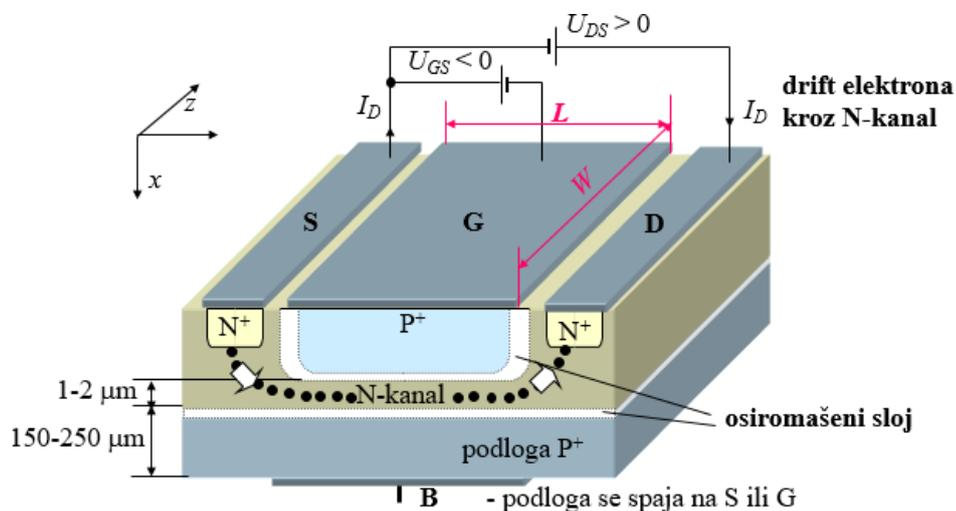
Sl. 2.1. Pojednostavljeni presjek N - kanalnog JFET-a [1]
