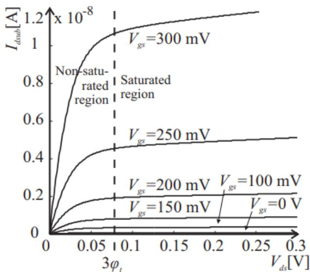
Sl. 4.1.  $I_{Dsub} - V_{DS}$  karakteristike N - kanalnog MOSFET [4]
