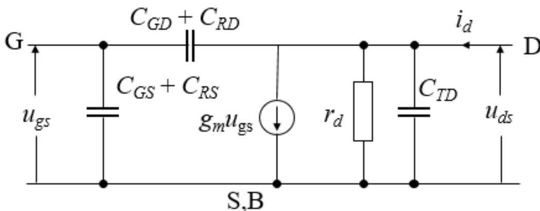
Sl. 3.4. Nadomjesni sklop na visokim frekvencijama [1]
