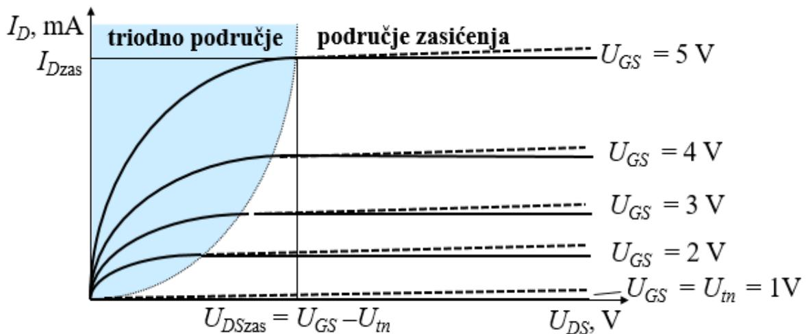
Sl. 3.1.  $I - U$  karakteristike N - kanalnog obogaćenog MOSFET-a [1]
