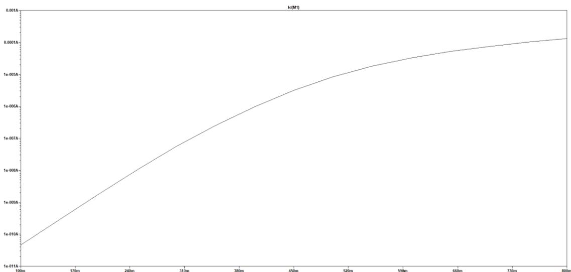
Sl. 6.3. Prijenosna karakteristika modela `tsmc180n`.
