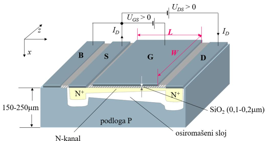
Sl. 2.3. Presjek N - kanalnog MOSFET-a [1]
