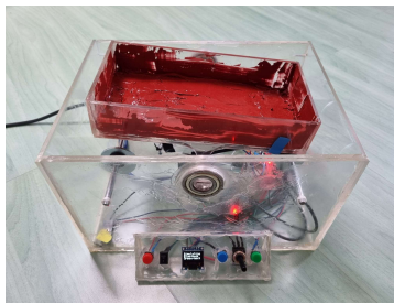
Sl. 4.3. Tresilica zakreće posudicu u desno
